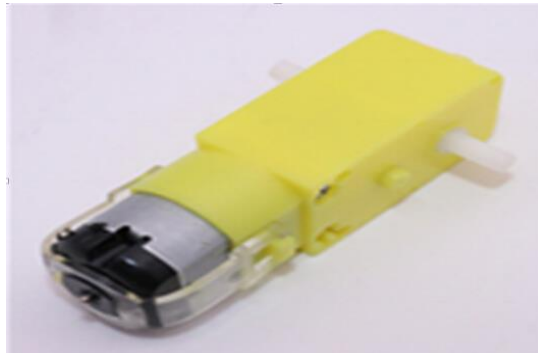
Slika 6: Istosmjerni motor sa četkicama korišten u projektu Izvor: Autor
