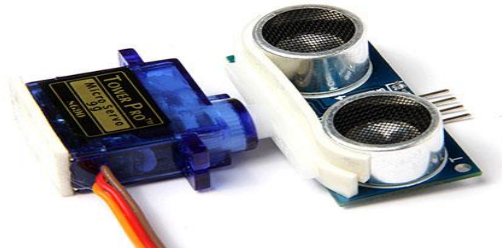
Slika 23: Spajanje ultrazvučnog senzora na servo motor Izvor: Autor
