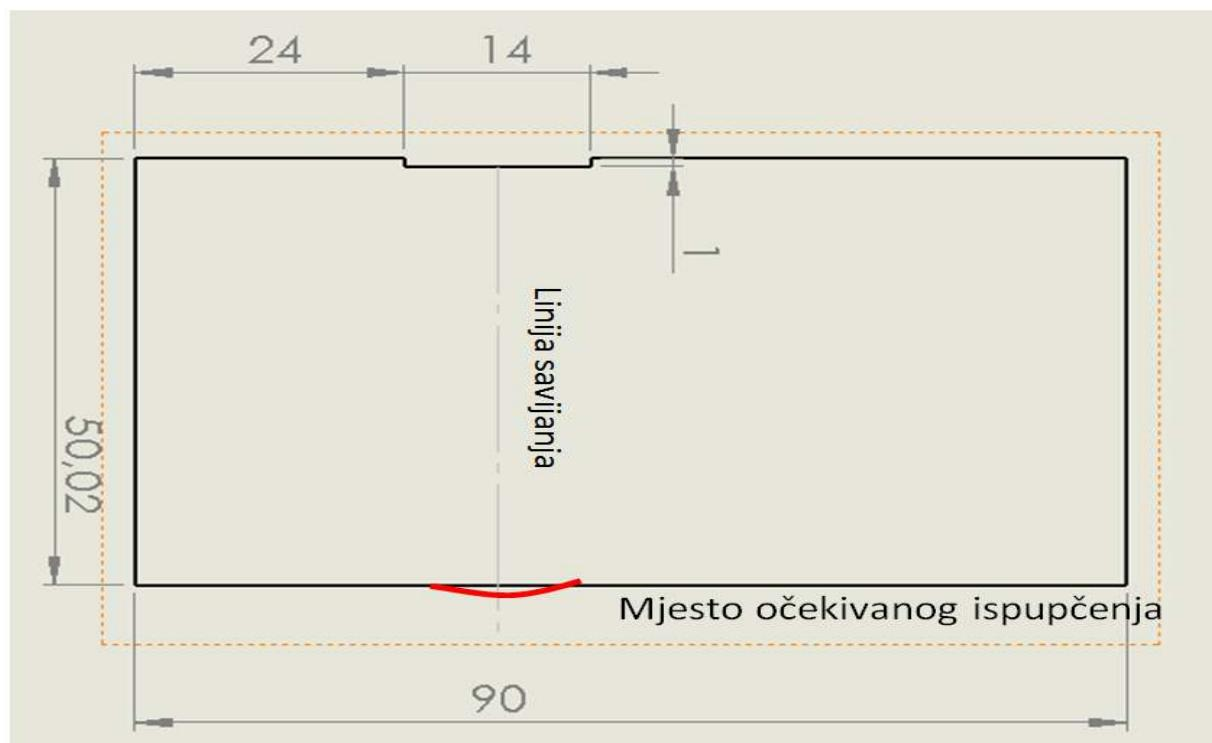
**Slika 21. Dimenzije dodanog reza za izbjegavanje ispuštenja**
