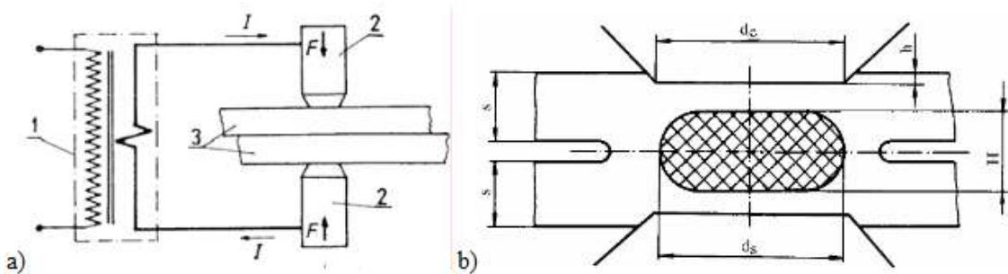
*Slika 33. Prikaz točkastog zavarivanja*
