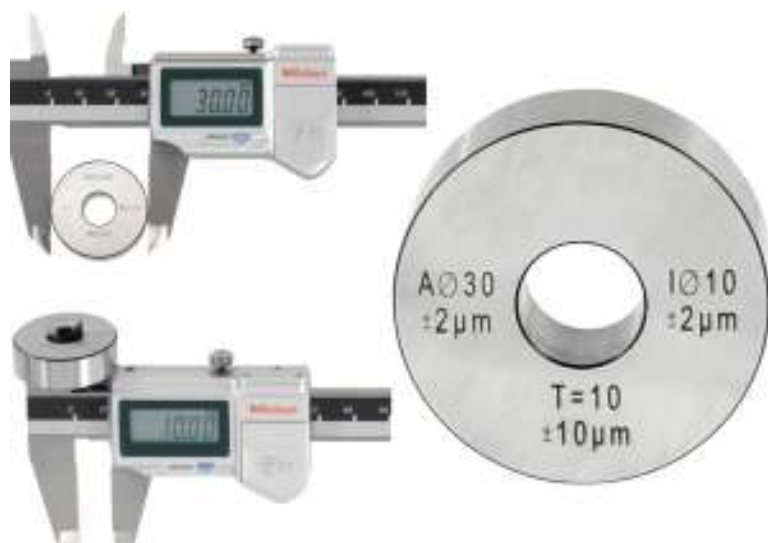
Slika 57. Prikaz kontrole pomičnog mjerila etalonom
