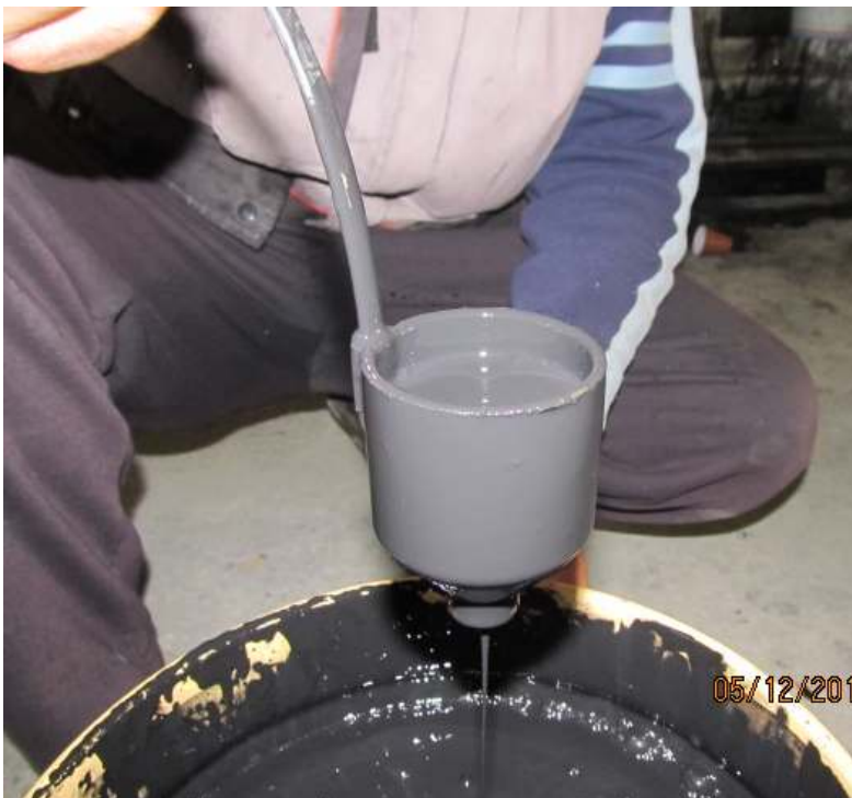
Slika 63. Mjerenje viskoznosti s DIN 4
