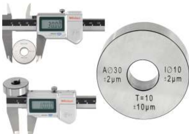
Slika 57. Prikaz kontrole pomičnog mjerila etalonom
