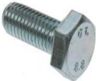
Vijak DIN 933 opisno je vijak sa šesterekutnom glavom, navojem po cijeloj dužini. Koristimo ga pri spajanju dijelova peći, spoj se ostvaruje maticama, insertnom maticom ili urezanim navojem na kontra poziciji. Koristimo ga gdje je potrebni čvrsti rastavljivi spoj na primjer poklopcu motora pužnog elevatora, spoju tijela peći i baze peći.
