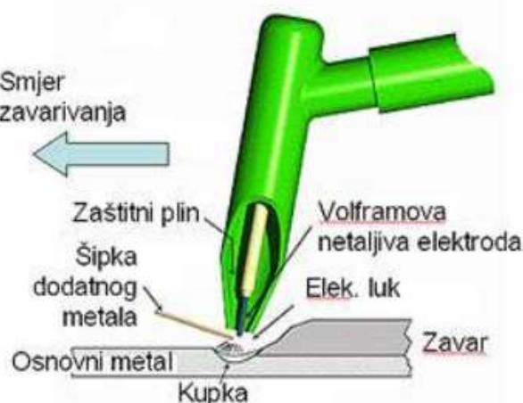
**Slika 31. Pojednostavljeni prikaz TIG postupka**
