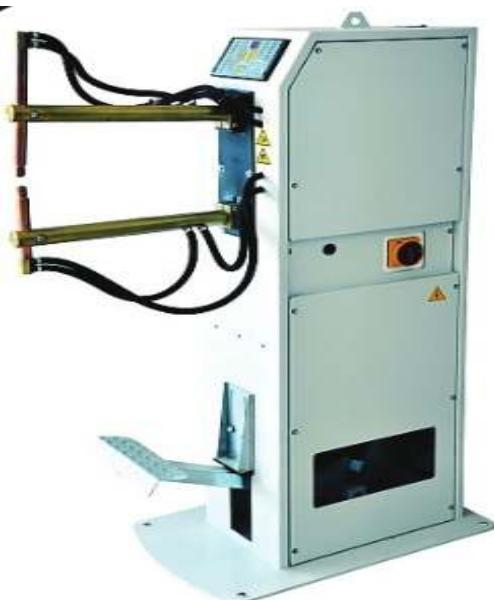
Elektrootporno zavarivanje obuhvaća grupu postupaka kod kojih se materijal zagrijava toplinom stvorenom električnim otporom, a zavareni spoj nastaje dodatnim djelovanjem sile pritiska između elektroda.
