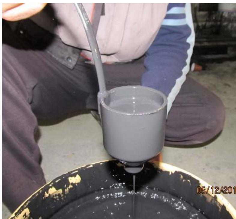
Slika 63. Mjerenje viskoznosti s DIN 4
