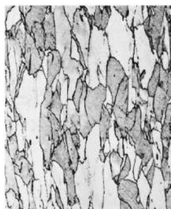
Slika 19. Osnovna mikrostruktura produžena u smjeru naprezanja
