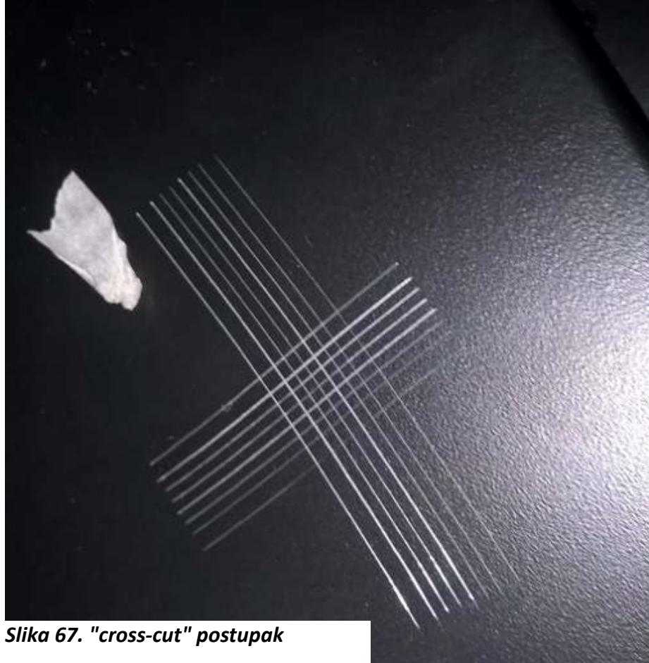
rešetka od 2mm. Slika 67 - na limu nastane mrežica od 25 kvadratića. Urezivanje se obavlja jednolikom brzinom i urez mora doći do podloge, ali ne smije zagrepsti preduboko. Nakon urezivanja rešetka se lagano početka četkom iz kompleta, a zatim se na mrežicu zalijepi ljepljiva vrpca, koja se potom naglo odlijepi. Nakon toga slijedi usporedba mrežice sa
