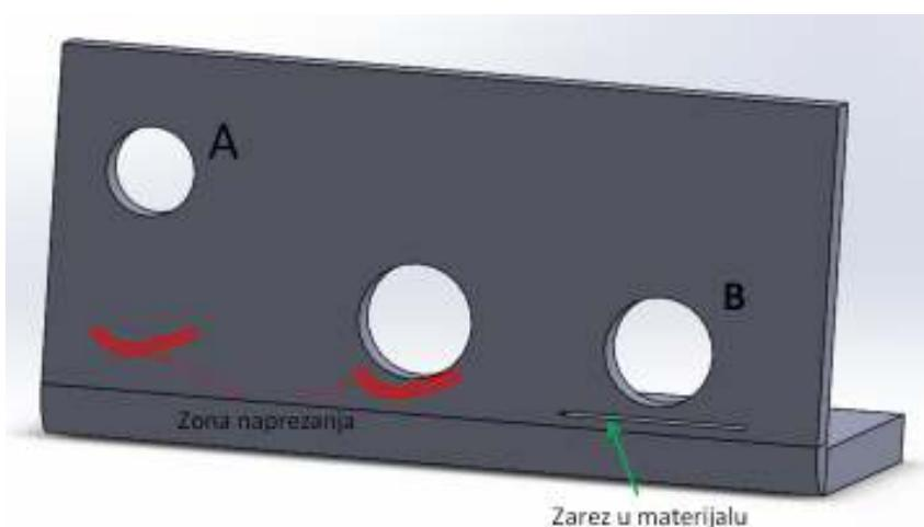
Na slici 23 prikazana su rješenja za izbjegavanje deformiranja otvora i provrta.
