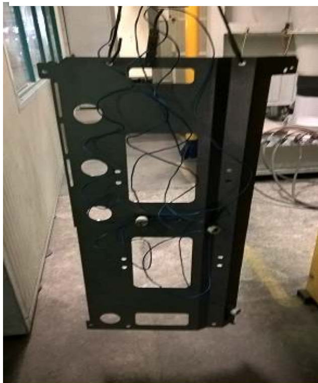
Slika 42. instrument za mjerenje temperatura na limu
