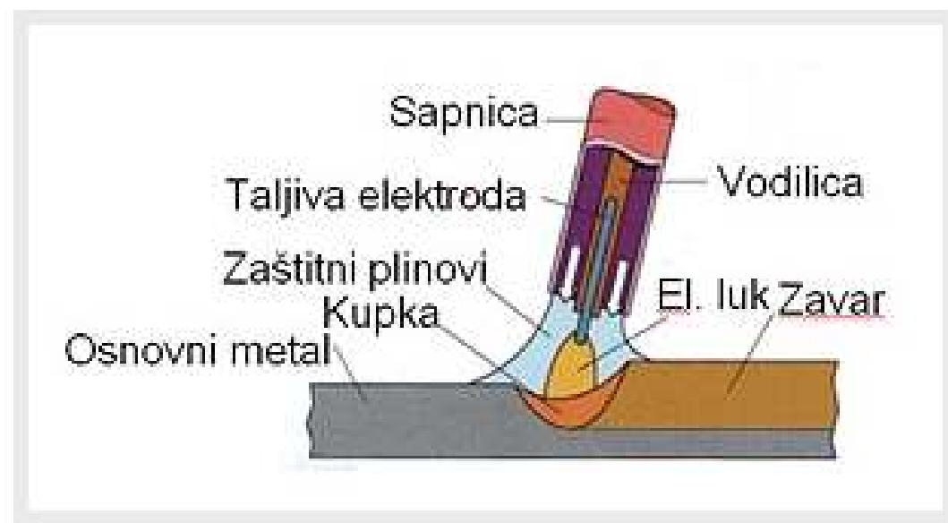
*Slika 29. Pojednostavljeni prikaz pojmove pri radu MIG/MAG postupkom*
