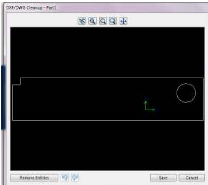
Slika 9 prikazuje poziciju iz slike 7. U formi 3d modela u .dxf formatu slika 9., koji je prilagođen za strojeve poput lasera ili programa za izradu simulacija savijanja.
