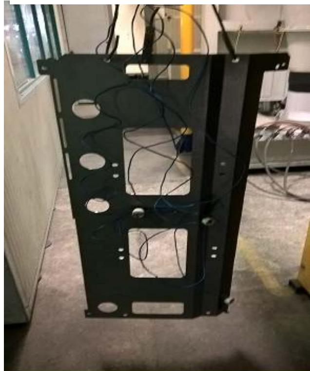
**Slika 42. instrument za mjerjenje temperaturu na limu**
