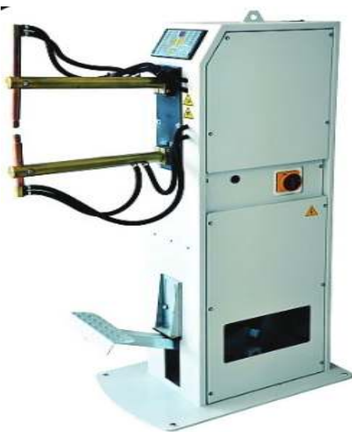
Slika 32. Aparat za točkasto zavarivanje
