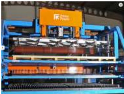
Slika 12. Automatizirani izmjenivač limova
