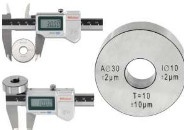
**Slika 57.Prikaz kontrole pomičnog mjerila etalonom**
