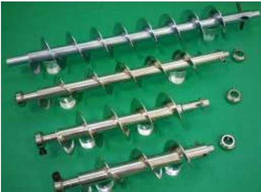
Slika 27. Pužni prijenosnici peleta
