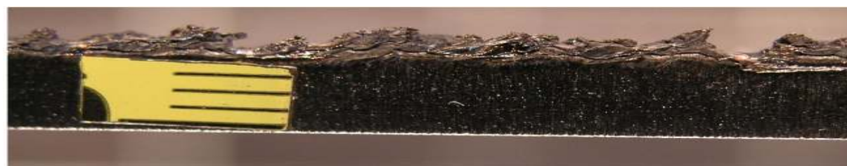
Slika 15. Lim izrezan sa srhom koji treba ukloniti i hitno namjestiti parametre stroja
