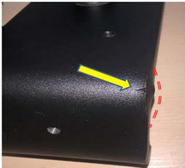
Slika 20. Prikaz loma materijala pri savijanju
