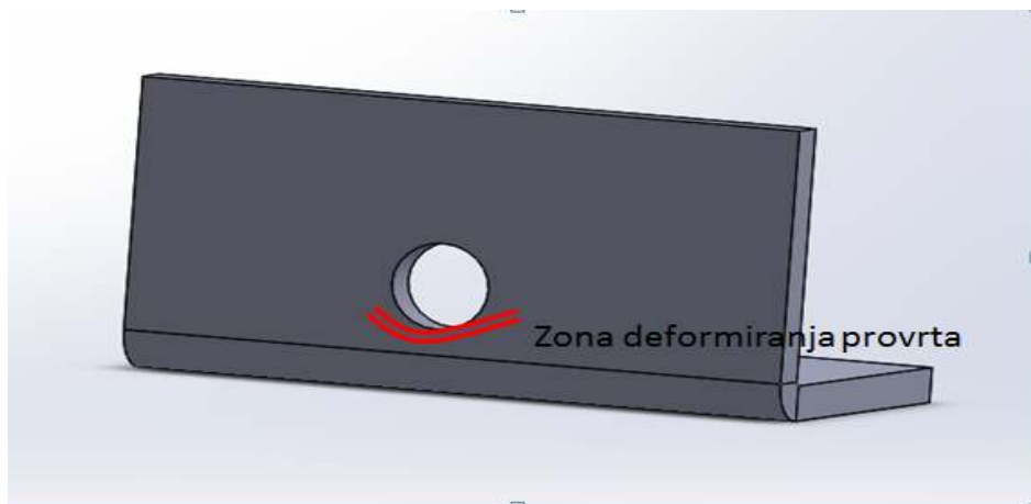
Slika 22. Prikaz provrta u zoni savijanja
