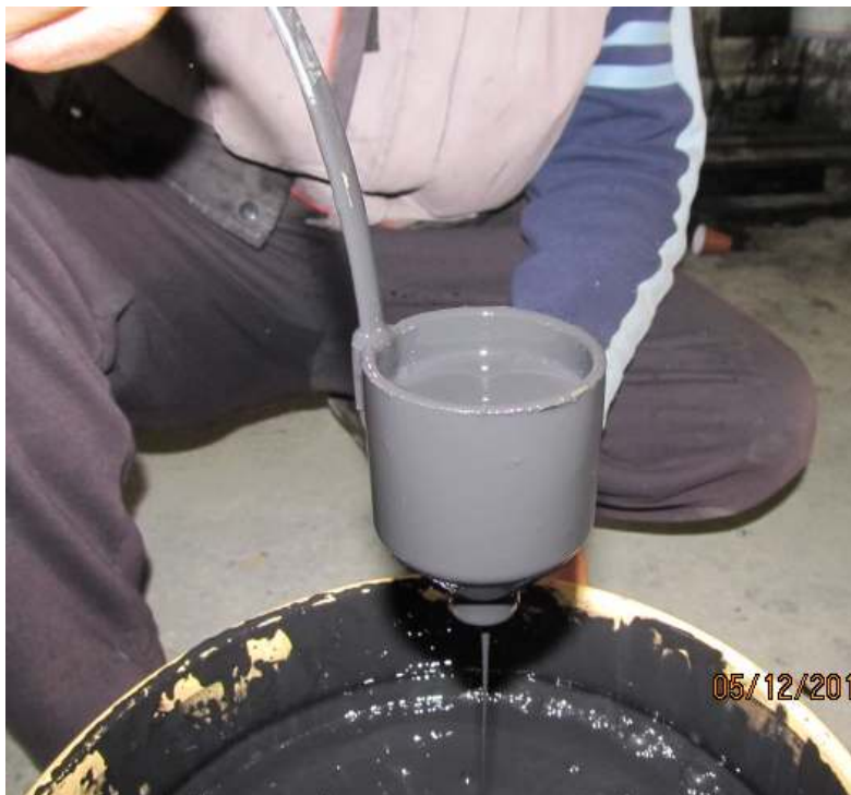
Slika 63. Mjerenje viskoznosti s DIN 4
