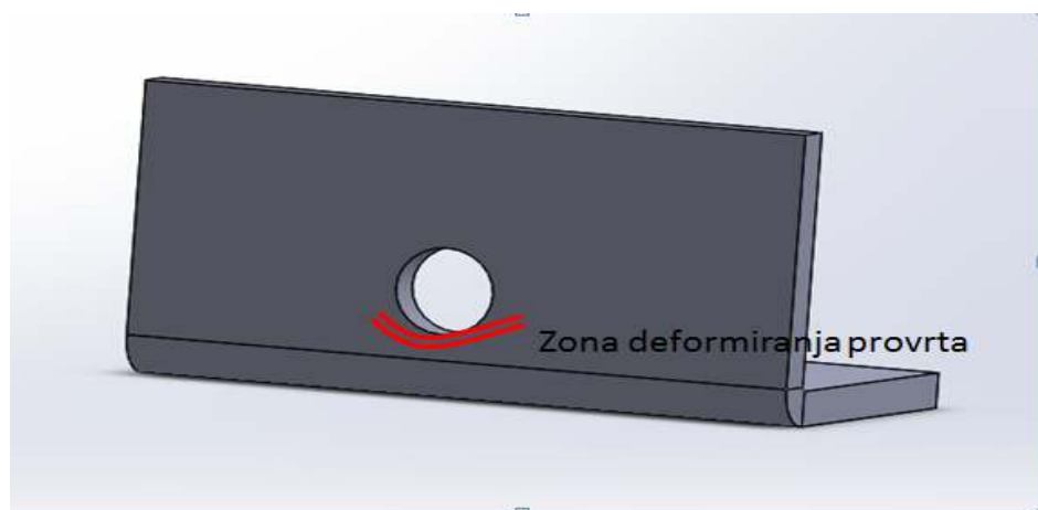
Slika 22. Prikaz provrta u zoni savijanja
