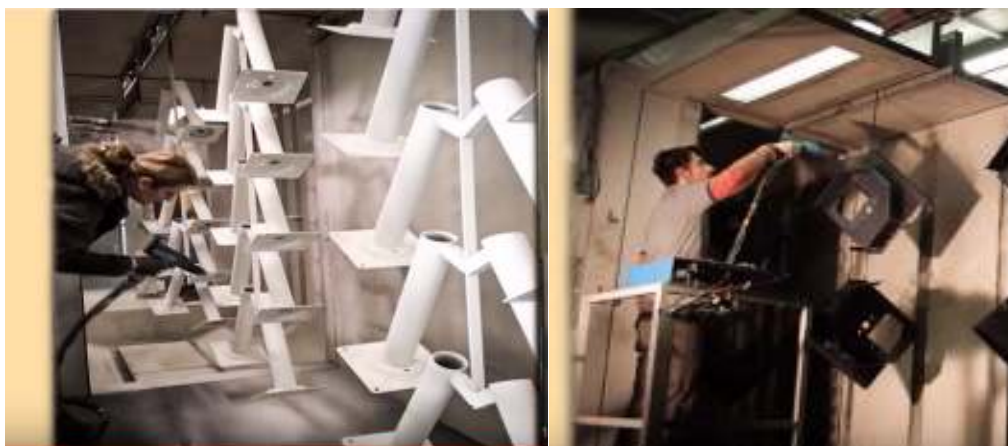
Slika 40. Ručno nanošenje praškaste boje
