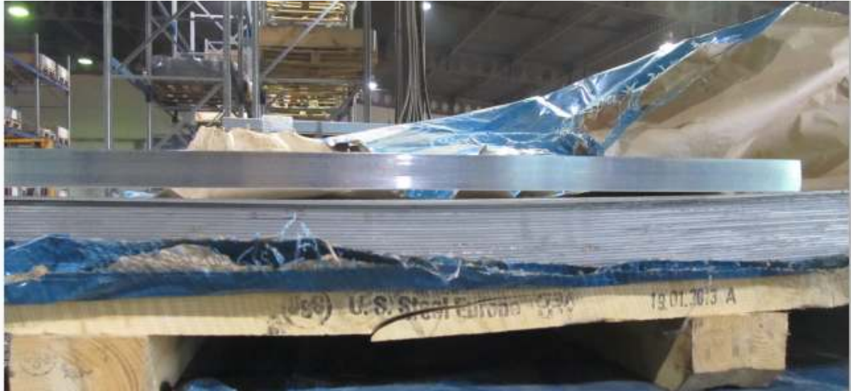
Slika 52. Lim isporučen sa greškom oblika
