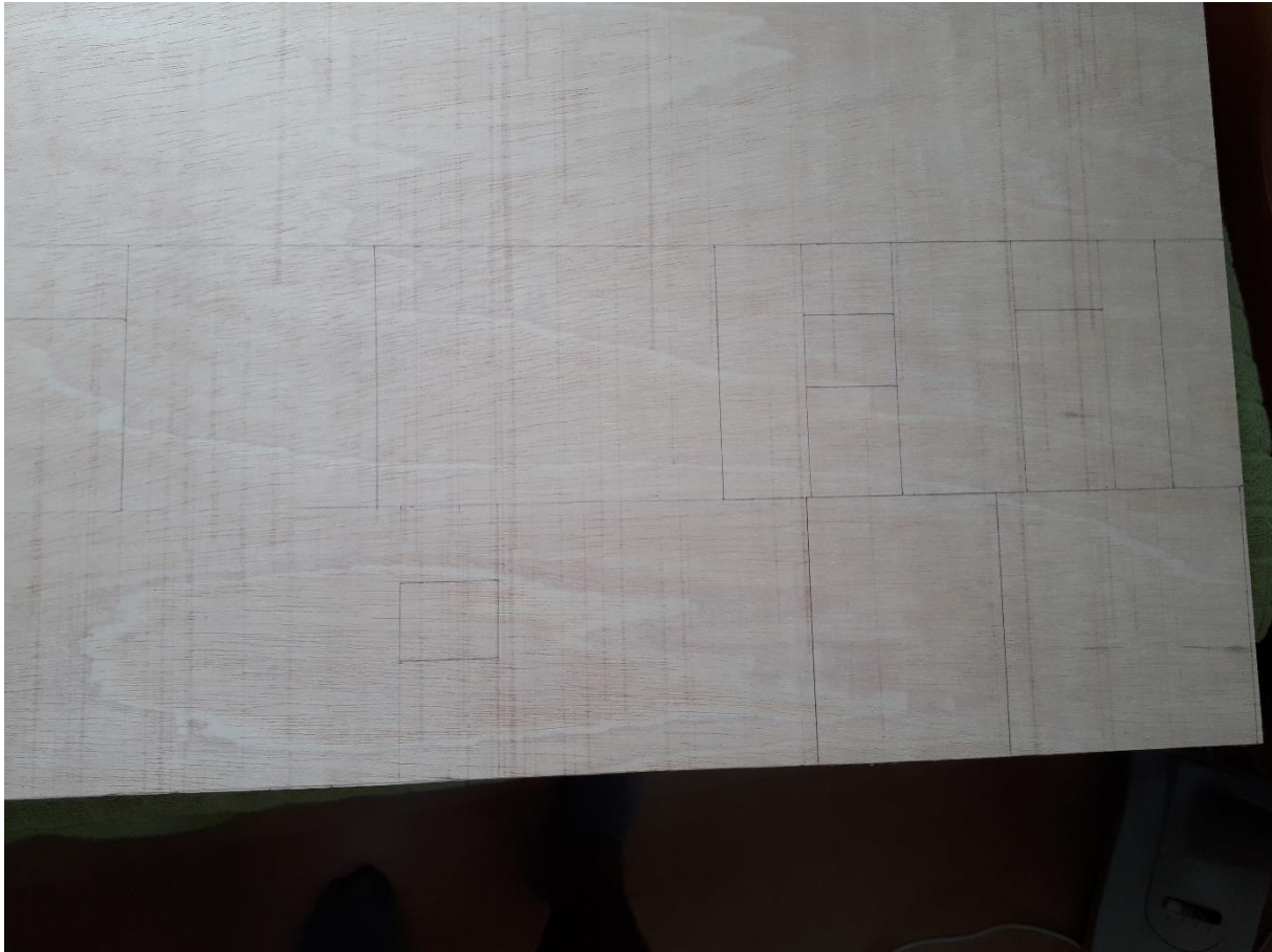
Slika 34. – Ocrtavanje linija za izrezivanje na šperploči
