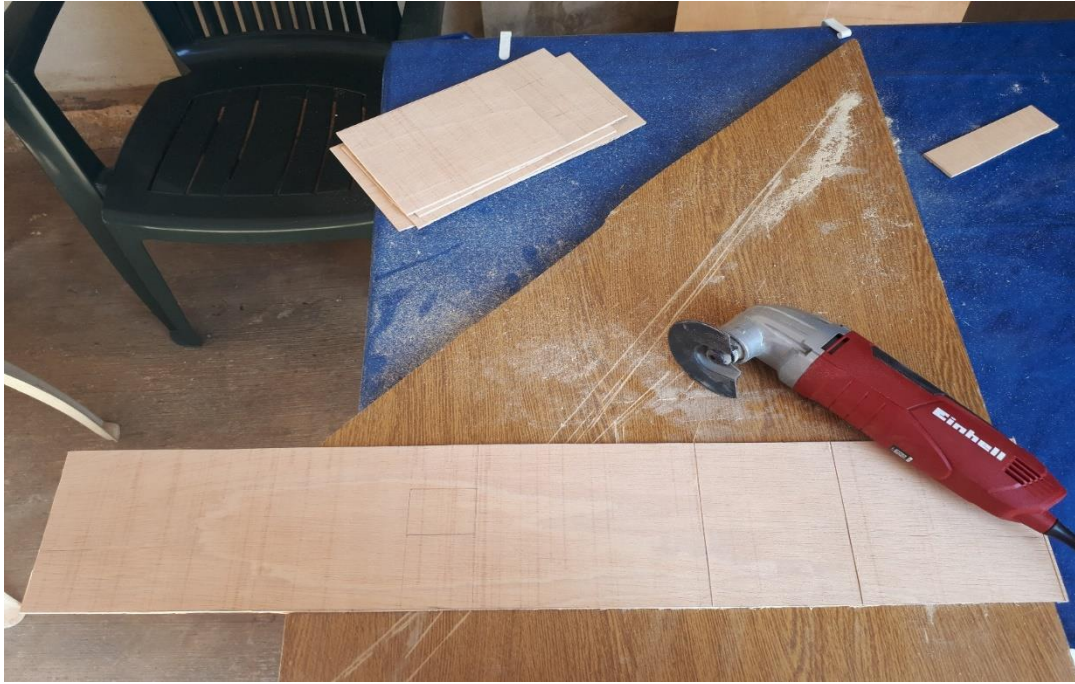
Slika 35. – Piljenje šperploče sa multifunkcijskim alatom
