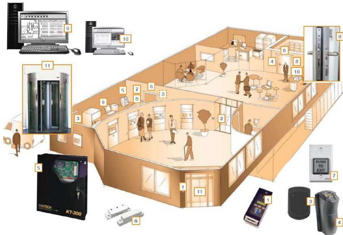
Slika 8-2 Sistem kontrole pristupa za poslovni objekt Oznake: 1-magnetski čitač bankovnih kartica, 2-interloking vrata, 3- čitač kartice, 4-biometrijski čitač otiska, 5- kontrolor, 6-magnetski kontakt, 7-tastatura za izlaz, 8-elektromehanička brava, 9-računar sa odgovarajućim serverom, 10-PC radna stanica, 11-sigurnosna ulazna vrata
