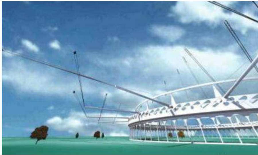
Slika 21: KiteGen kao "vrtuljak" za primjenu na kopnu
