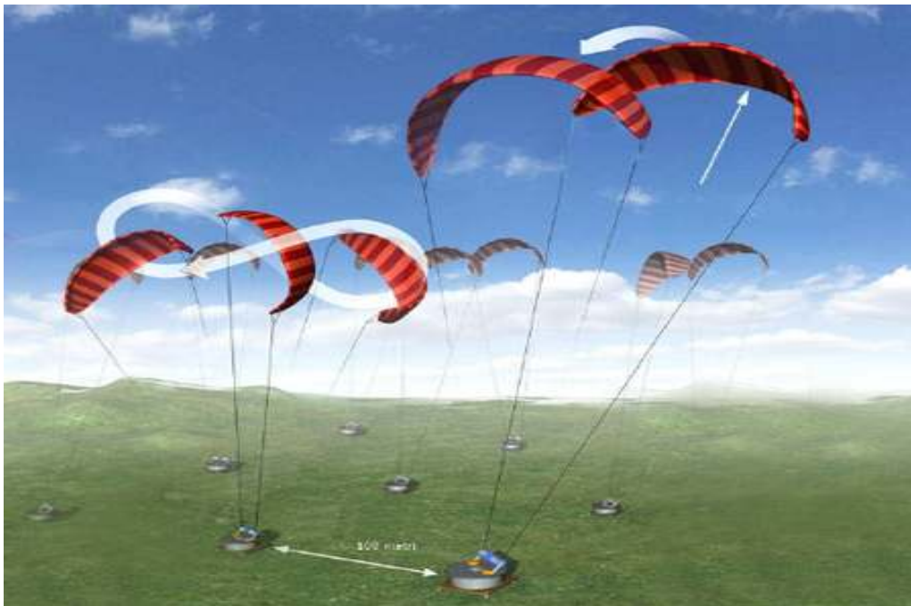
Slika 19: KiteGen za kopnene i morske vjetroelektrane
