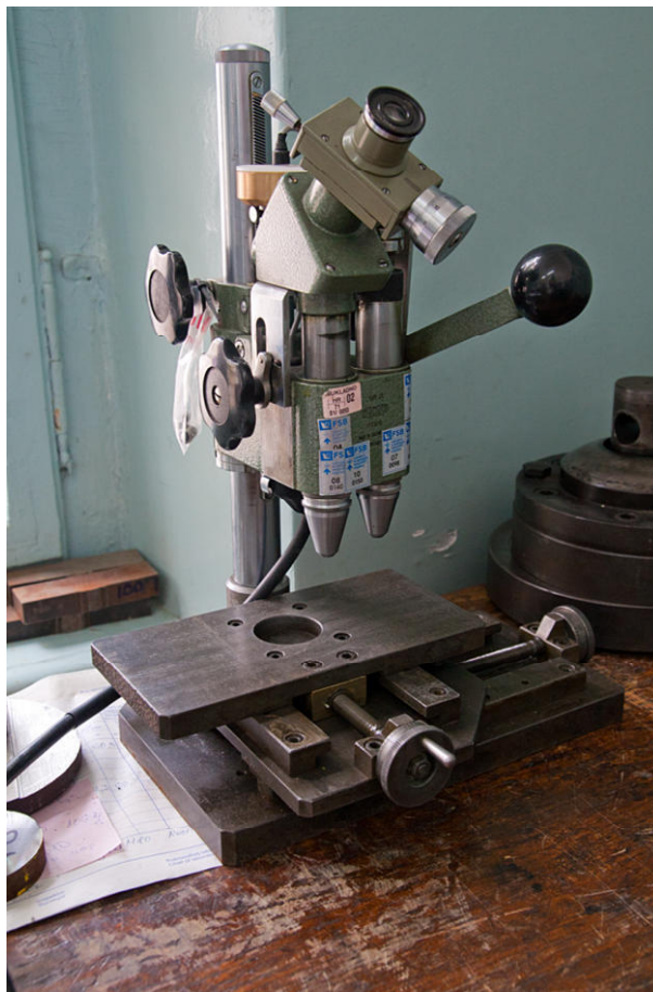
Slika 41. Uređaj za mjerenje tvrdoće Vickers metodom
