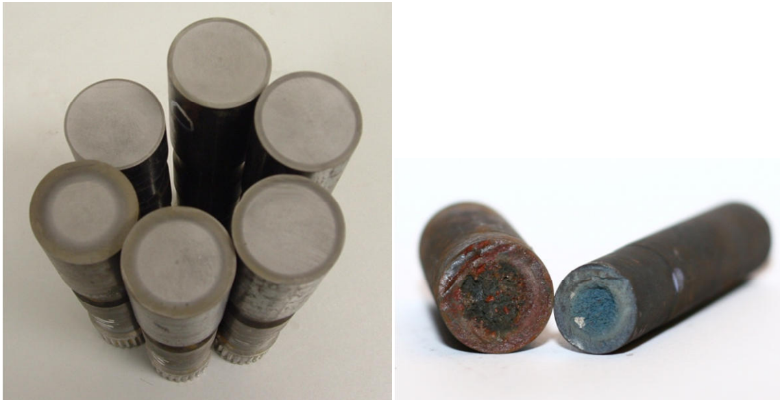
Slika 33. Probne epruvete za kontrolu pougljičavanja
