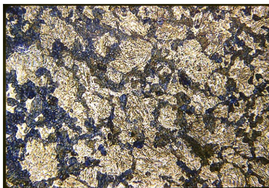
Slika 43. Metalografski snimak podpovršinskog – prijelaznog sloja
