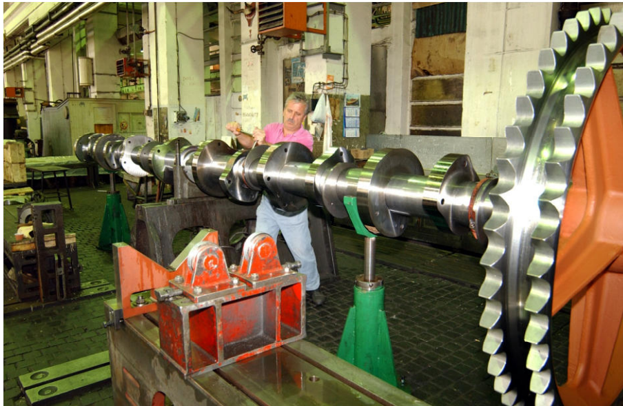
Slika 6. Sastavljanje bregaste osovine
