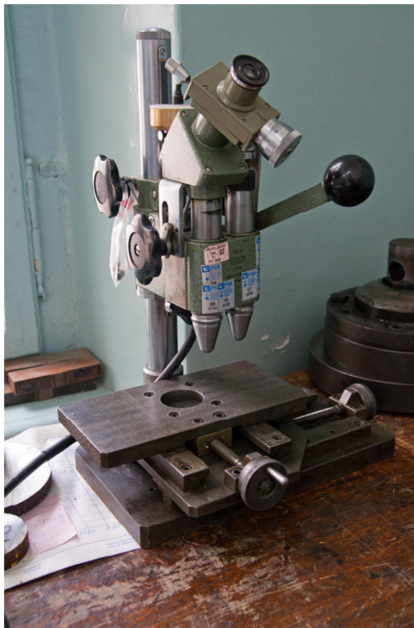
Slika 41. Uređaj za mjerenje tvrdoće Vickers metodom
