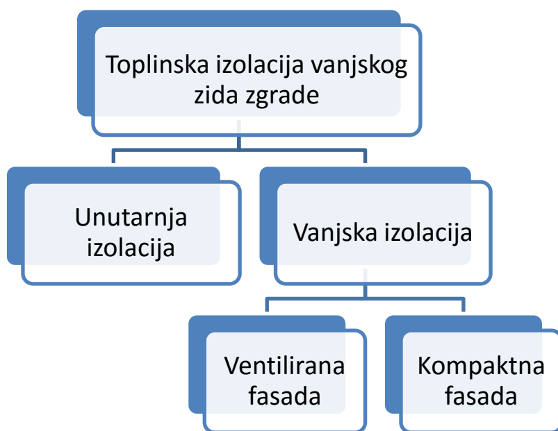
Grafikon 1. Toplinska izolacija vanjskog zida zgrade
