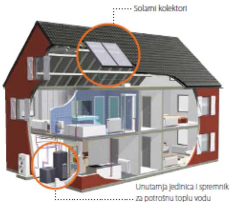
Slika 16: solarni kolektori spojeni na unutarnju jedinicu (izvor: Daikin Heating katalog 2013)
