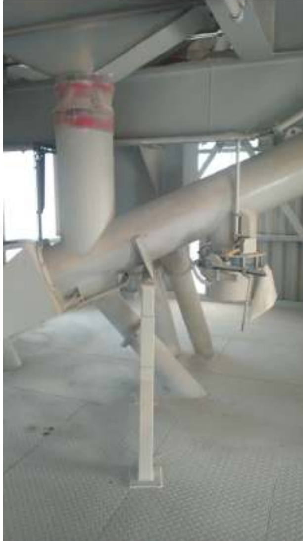
Slika 14.: Kliznica sa sita koja vodi u separator
