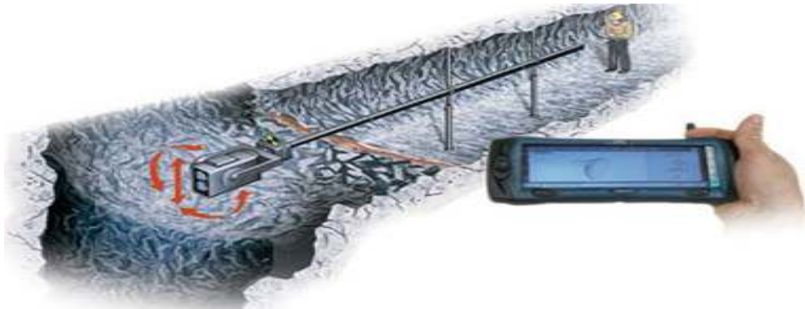
Slika 16. Prikupljanje vektorskih podataka geodetskim izmjerom
