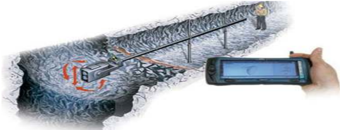
Slika 16. Prikupljanje vektorskih podataka geodetskim izmjerom
