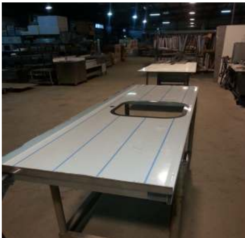
Slika 22: Radna površina (priprema za varenje); Izvor:Interne slike poduzeća Fusio d.o.o.
