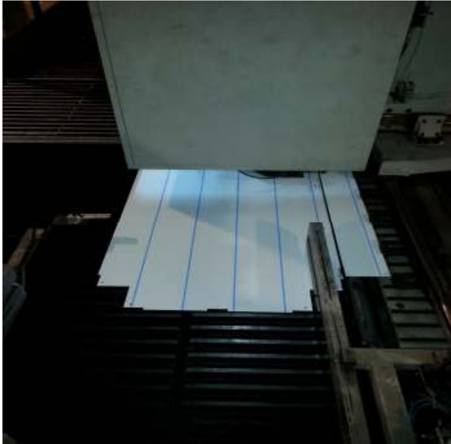
Slika 17: Štanca CNC(odštancan lim); Izvor:Interne slike poduzeća Fusio d.o.o.
