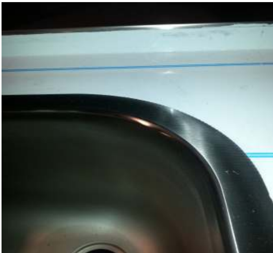
Slika 24: Radna površina (detalj vara prije obrade); Izvor:Interne slike poduzeća Fusio d.o.o.
