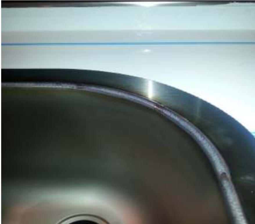
Slika 24: Radna površina (detalj vara prije obrade); Izvor:Interne slike poduzeća Fusio d.o.o.
