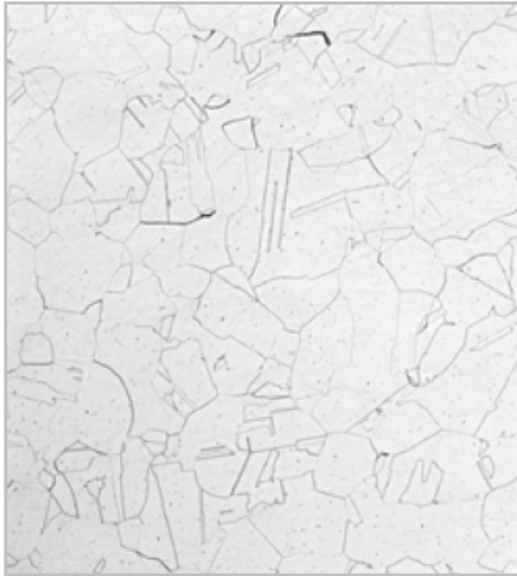
Slika 2: mikrostruktura austenitnog nehrđajućeg čelika (Rede 2012)
