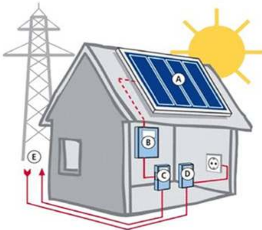
Slika 14. Fotonaponski sustav priključen na javnu mrežu preko kućne instalacije
