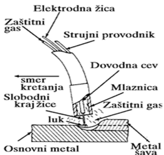
Slika 20: Elektrolučno zavarivanje topljivom elektronom u zaštiti plina
