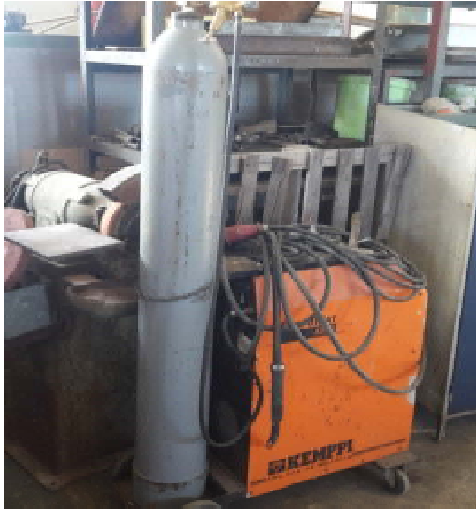
Slika 16: Sistem dovođenja žice kabinski korišten u izradi konstrukcije
