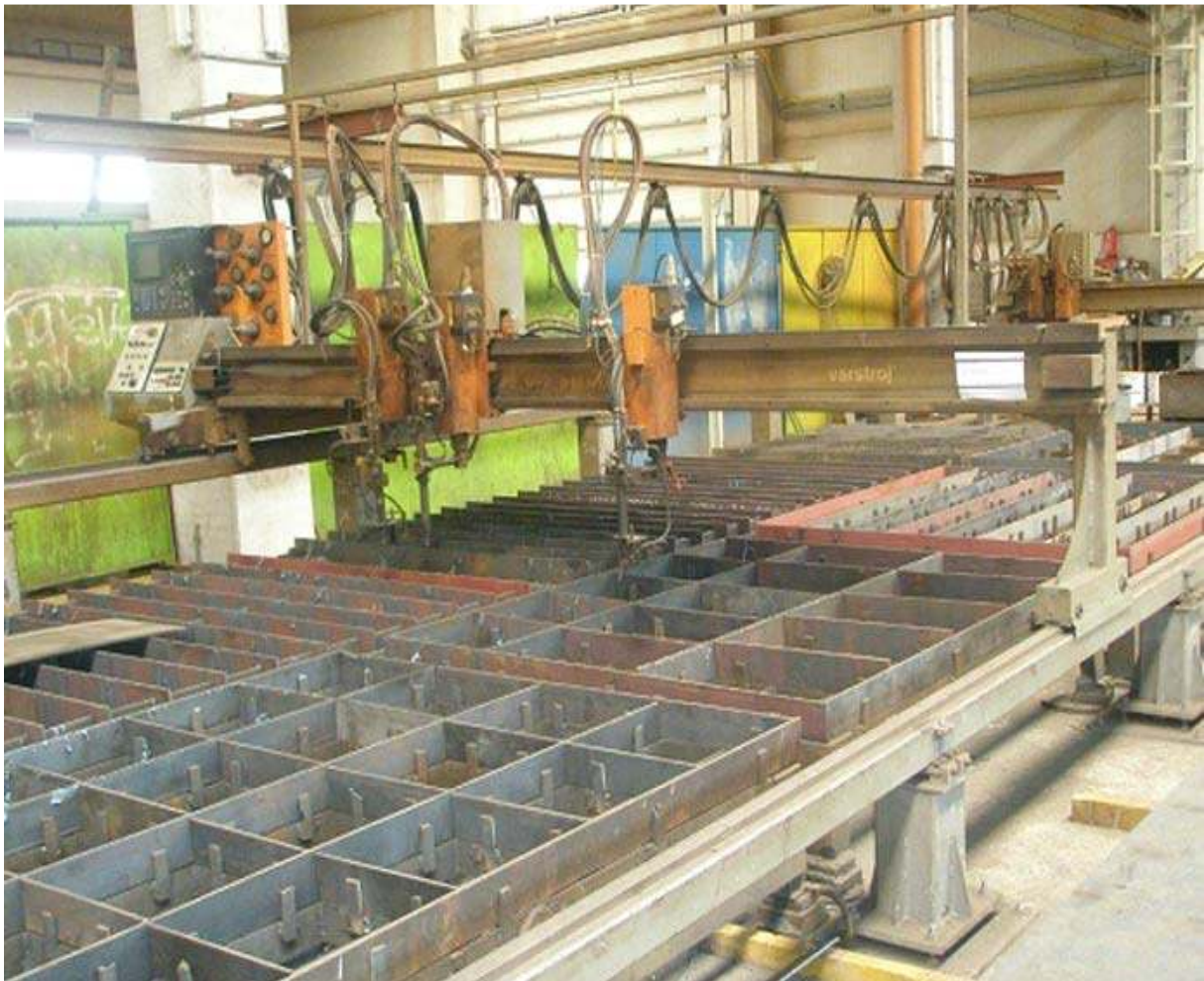
Slika 8: Pantograf za rezanje metala
