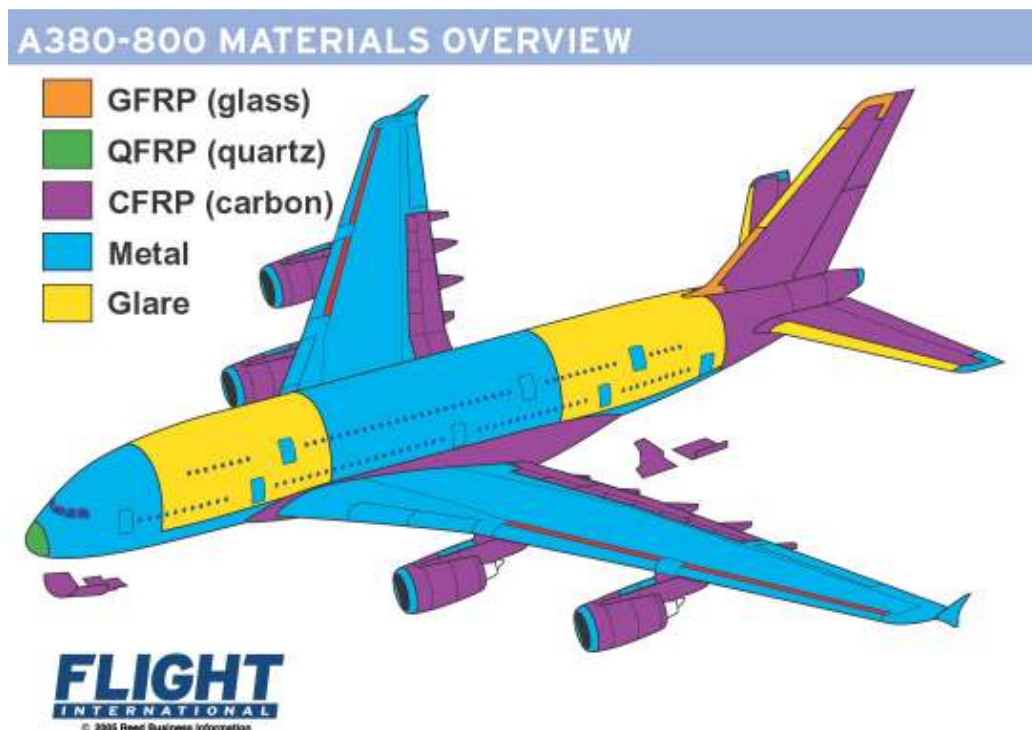
Slika 15. Struktura zrakoplova Airbus 380
