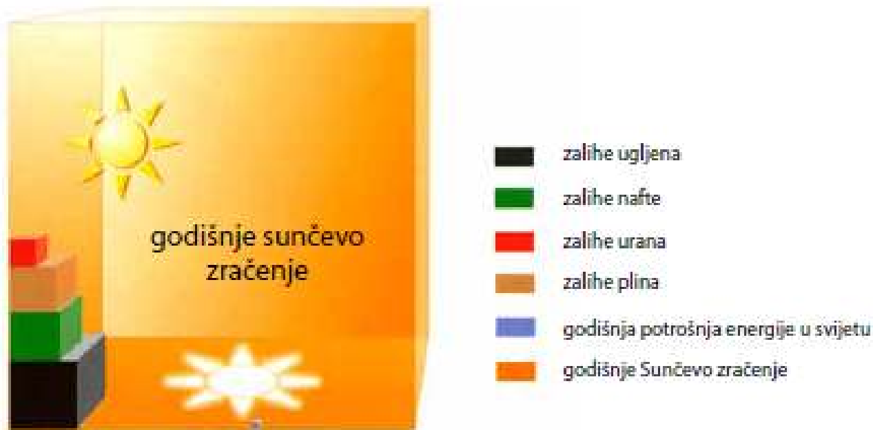
Slika 7.: Godišnje sunčevo zračenje na površini zemlje u usporedbi sa zalihama
