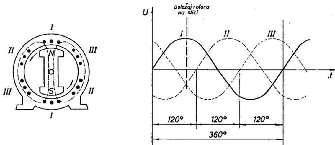
Slika 11. Generiranje trofazne struje okretanjem magneta u statoru s 3 nezavisna namota [6]
