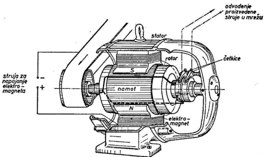
Slika 8. Generator s elektromagnetima na statoru [6]
