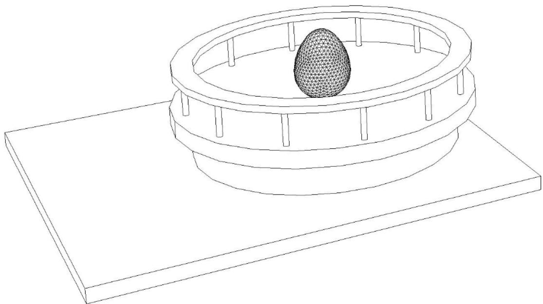
Slika 16. Model teslinog jajeta za demonstarciju okretnog magnetskog polja
