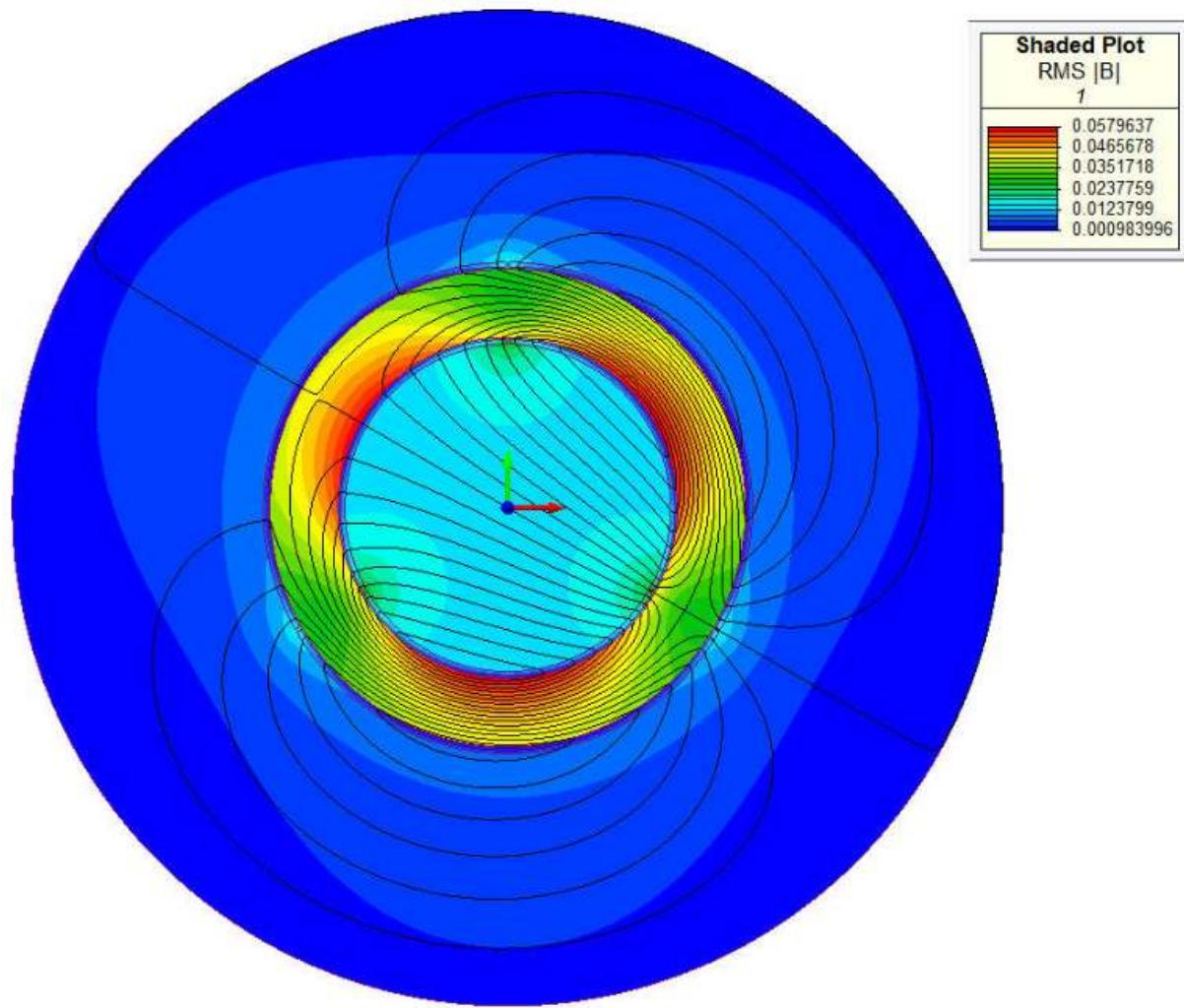
Slika 20. Magnetske silnice i razdiobe magnetske indukcije
