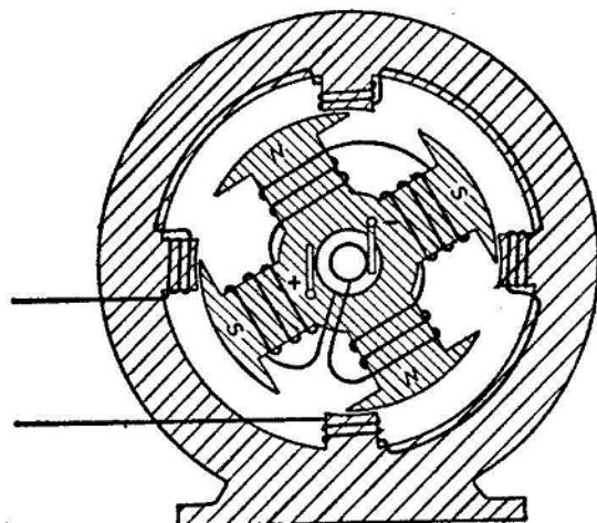
Slika 10. Smjer motanja namota kod višepolnih generatora [6]
