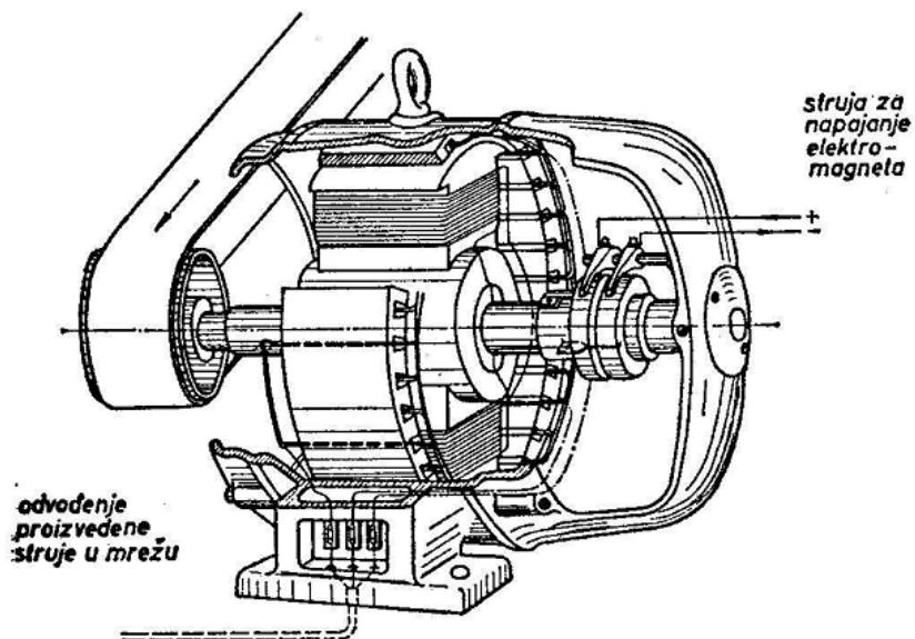
Slika 9. Generator s elektromagnetima na rotoru [6]
