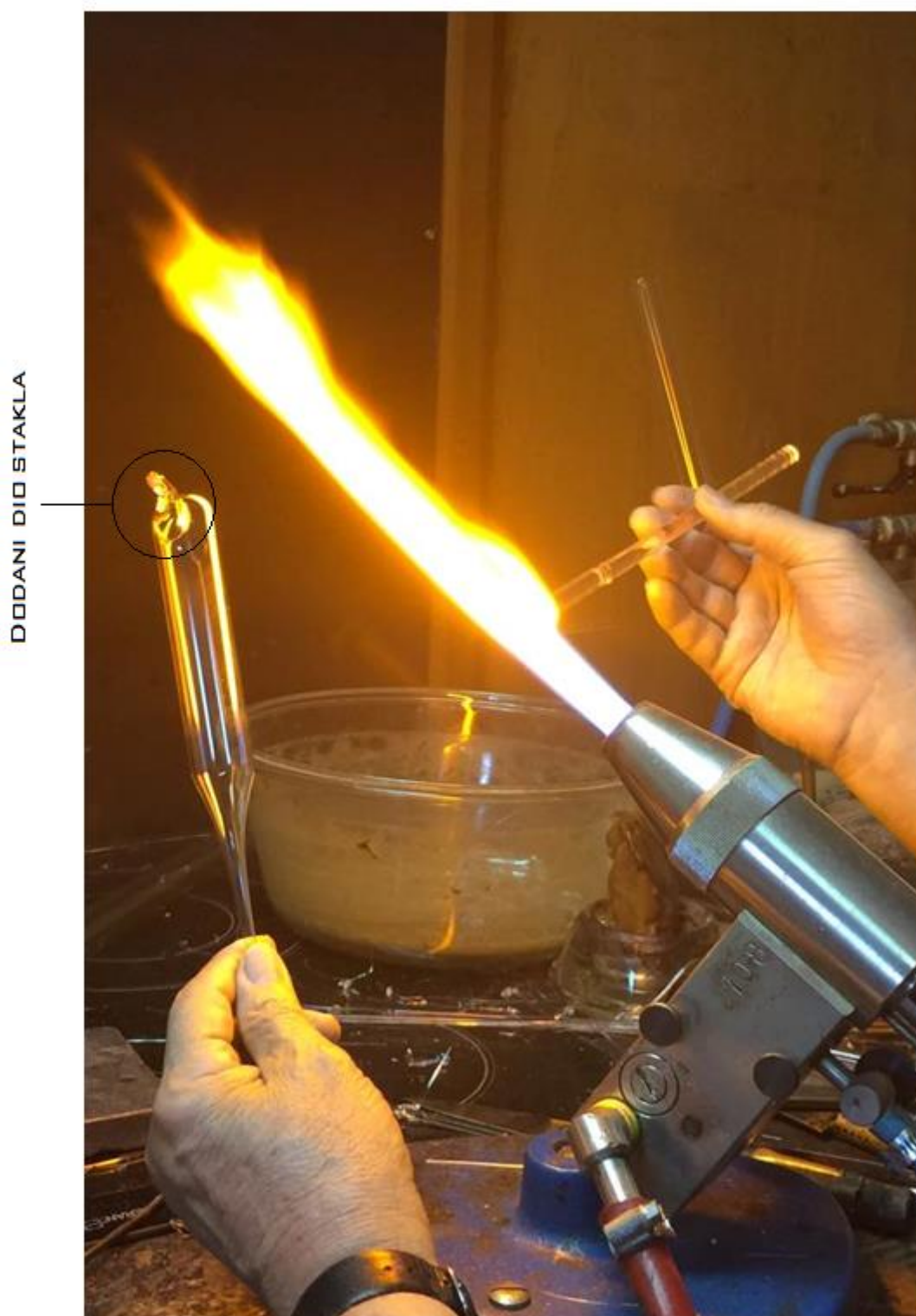
Slika 5.20. Taljenje staklene šipke
