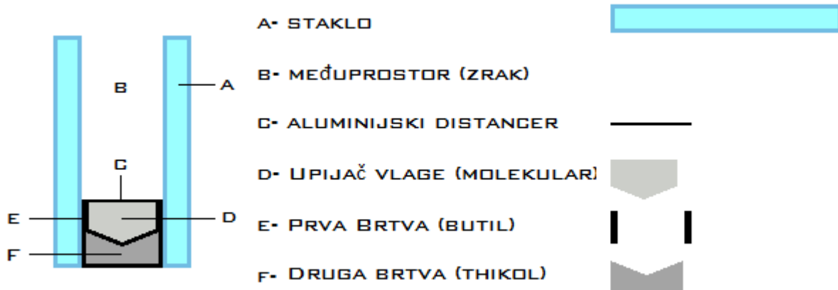
Slika 4.7. Struktura izolacijskog stakla
