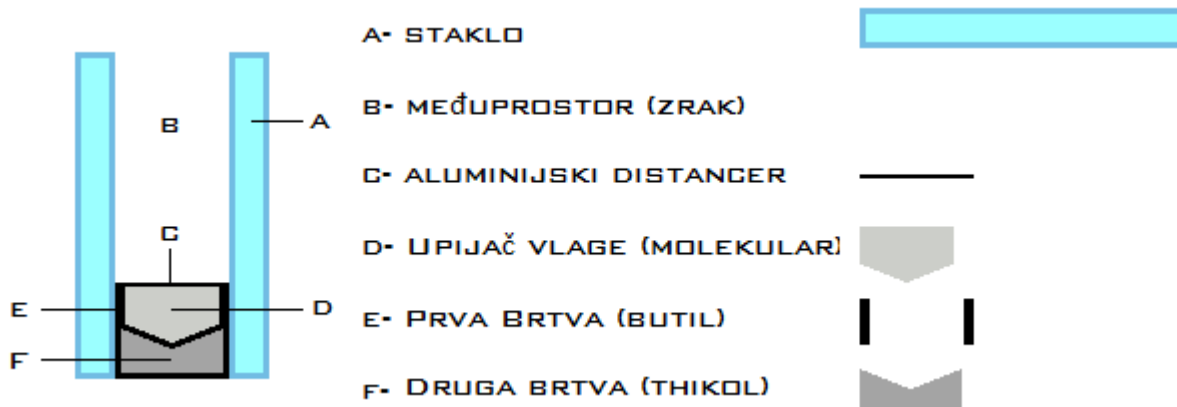
Slika 4.7. Struktura izolacijskog stakla
