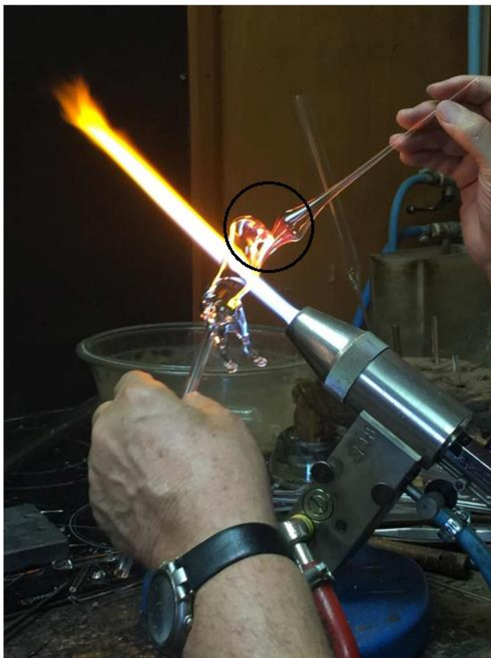
Slika 5.26 Odvajanje staklene cijevi i formiranje modela glave
