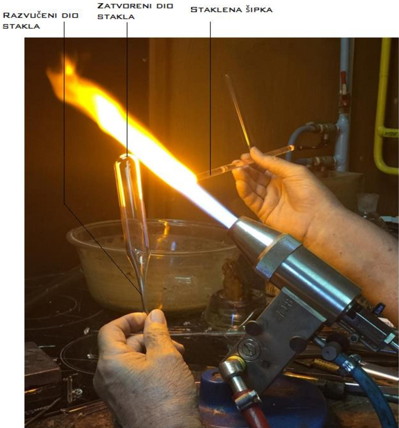
Slika 5.19. Pripremljeno staklo za izradu figurice
