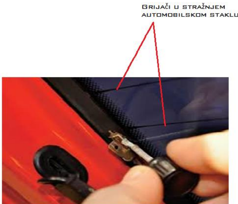
Slika 3.9. Grijači u staklu napravljeni putem sitotiska
