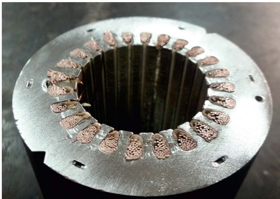
Slika 21 Izgled statorskog paketa bez čeone strane namota
