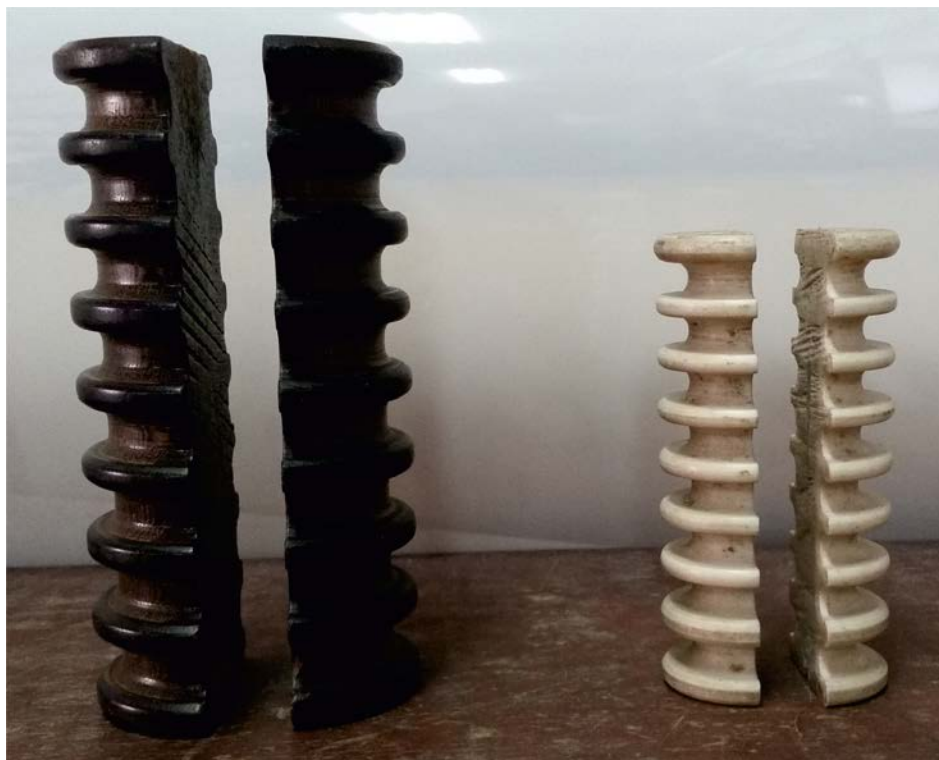
Slika 36 Radionički kalupi za namatanje svitaka sa jednakim korakom
