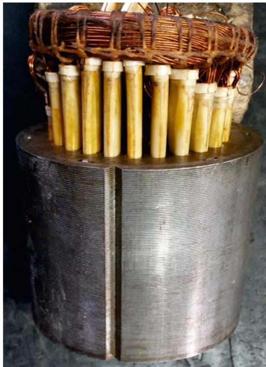
Slika 22 Izvlačenje namota iz statorskog paketa
