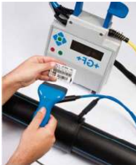
Slika 4.4.3.4. Uređaj za zavarivanje elektrospojnice za PEHD [5]
