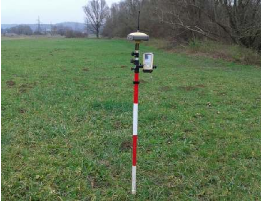
Slika 6.2.2. GNSS prijamnik sa svom opremom potrebnom za iskolčenje cjevovoda [2]
