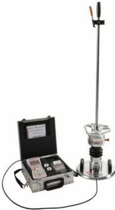
Slika 6.6.4. Dinamička ploča za ispitivanje zbijenosti [13]
