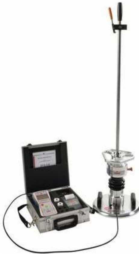
Slika 6.6.4. Dinamička ploča za ispitivanje zbijenosti [13]
