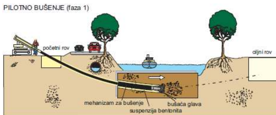
Slika 4.8.2.1. Metoda horizontalnog bušenja faza 1. [8]
