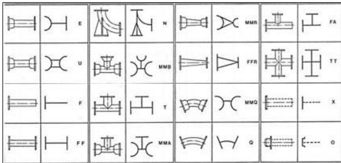
Slika 4.6.2. Sheme i oznake nekih lijevano željeznih fazona prema DIN – u [6]
