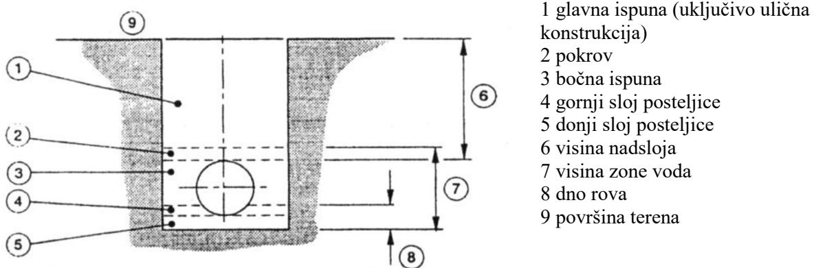
Slika 4.2.1. Poprečni presjek rova sa položenim vodom [2]
