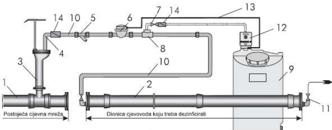
Slika 5.2.1. Shema postrojenja za dezinfekciju cjevovoda [8]
