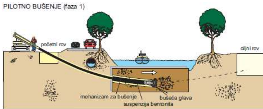
Slika 4.8.2.1. Metoda horizontalnog bušenja faza 1. [8]
