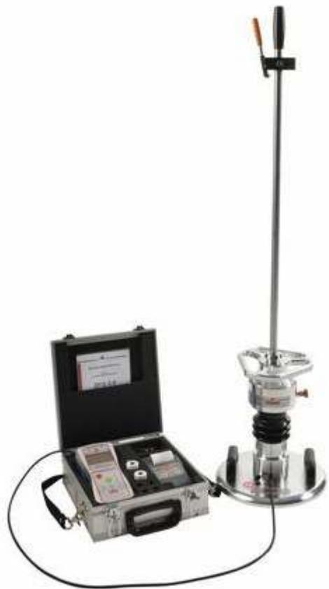
Slika 6.6.4. Dinamička ploča za ispitivanje zbijenosti [13]
