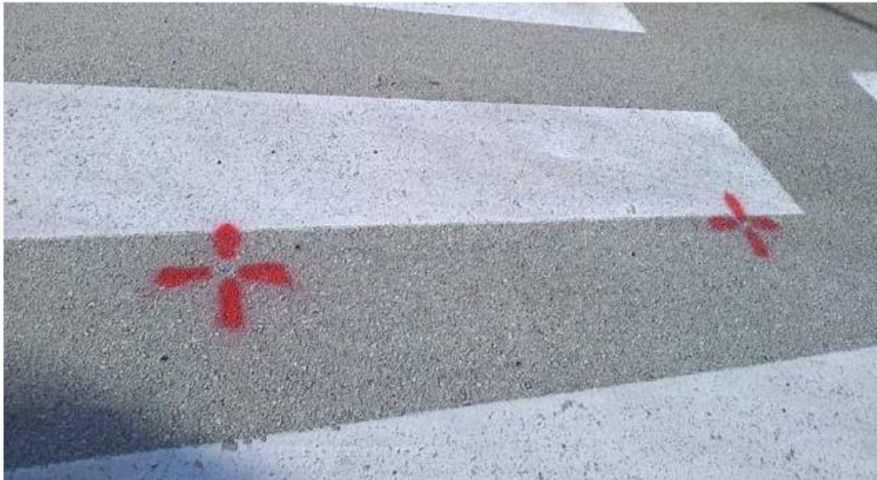
Slika 6.2.1. Iskolčene točke stabilizirane bolcnom na asfaltu [2]
