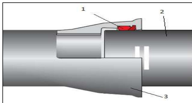
Slika 4.4.1.4. Tyton spoj za cijevi od nodularnog lijeva [8]
