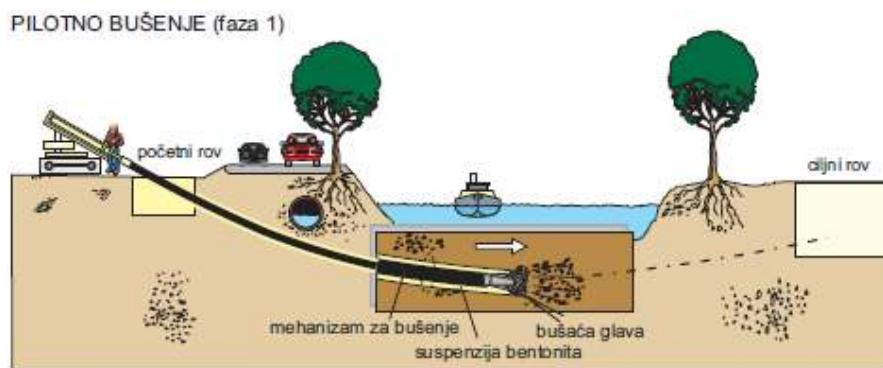
Slika 4.8.2.1. Metoda horizontalnog bušenja faza 1. [8]
