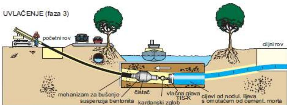
Slika 4.8.2.3. Metoda horizontalnog bušenja faza 3. [8]
