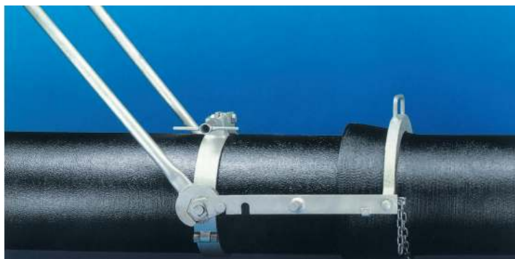
Slika 4.4.1.5. Alat za ručno spajanje cijevi od nodularnog lijeva [8]
