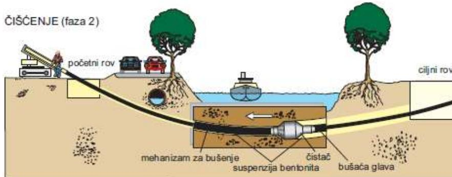
Slika 4.8.2.2. Metoda horizontalnog bušenja faza 2. [8]
