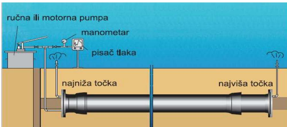
Slika 5.1.1. Tlačna proba [8]
