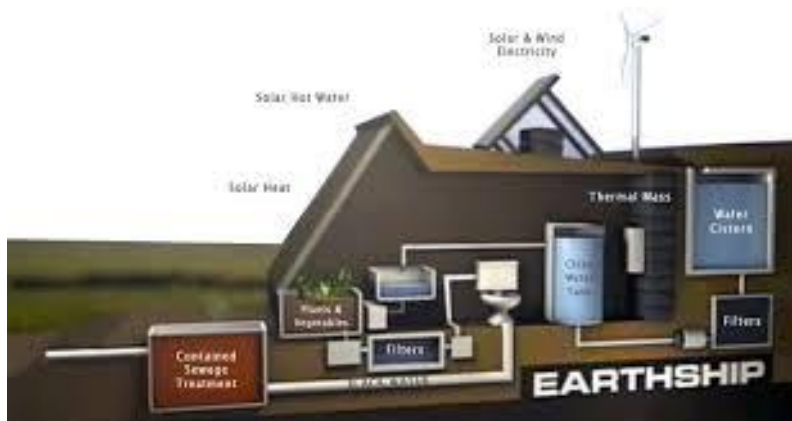
Slika 43. Bočni prikaz Earthshipa i sustava koje posjeduje
