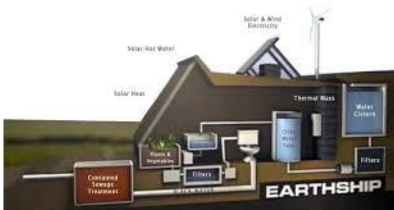
Slika 43. Bočni prikaz Earthshipa i sustava koje posjeduje
