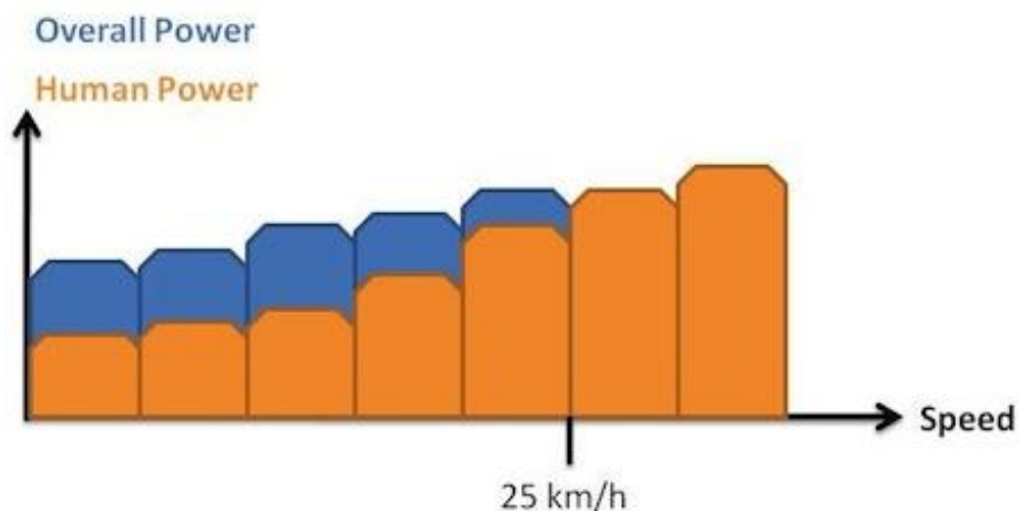
Slika 7.: Utrošak ljudske snage i ukupna snaga bicikle dobivena pri određenim brzinama
