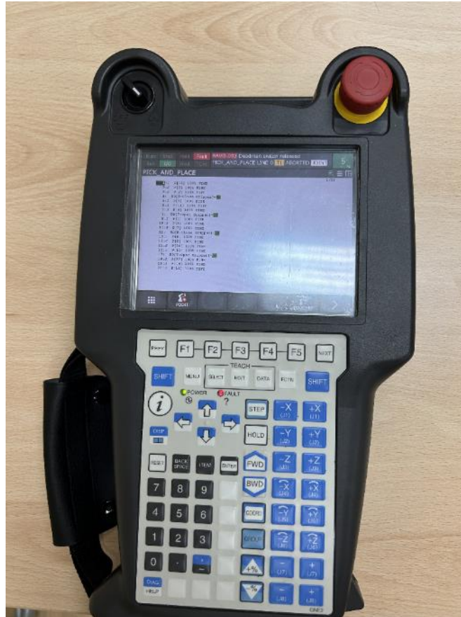
Slika 11. „Teach pendant“ upravljački uređaj robota Izvor: autor
