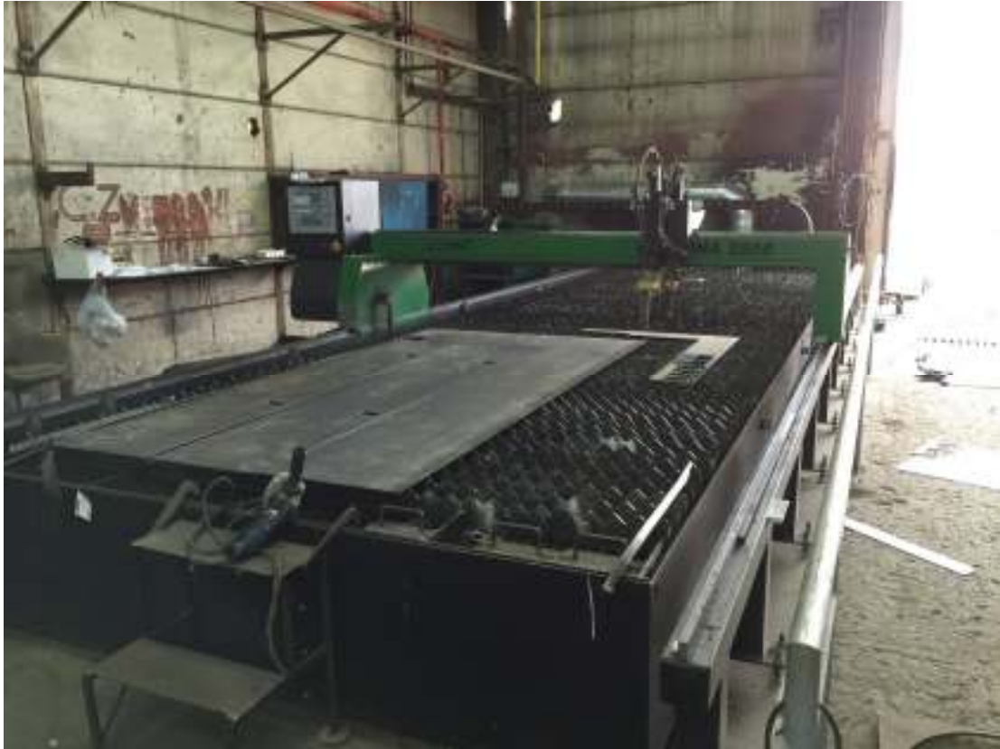
Slika 11. Prikaz CNC stroja za rezanje plazmom.
