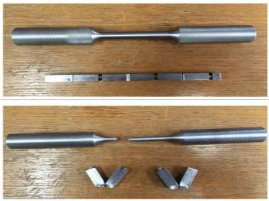
Slika 7. Epruvete prije i nakon ispitivanja.
