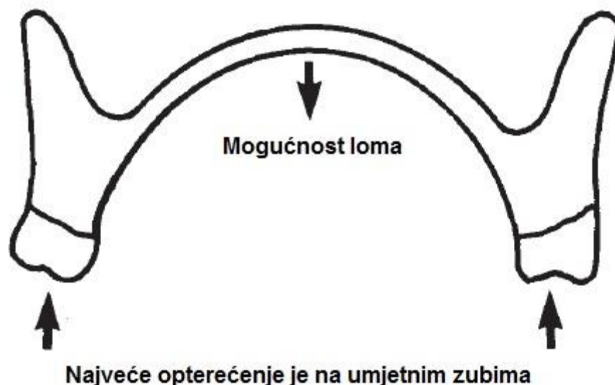
Slika 3.3. Prikaz opterećenja potpune zubne proteze i mjesto mogućeg nastanka loma
