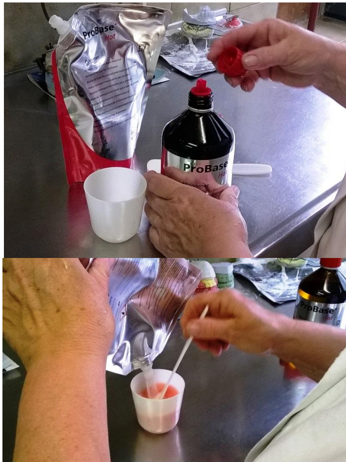
Slika 4.54. Ulijevanje tekućeg metil-metakrilata u plastičnu posudu (gore) i dodavanje poli(metil-metakrilata) u prahu (dolje)
