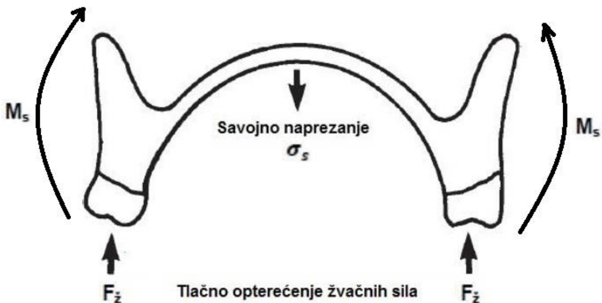
Slika 2.3. Djelovanje žvačnih (tlačnih) sila F_z na bočne umjetne zube; nastanak momenta savijanja M_s na bokovima baze potpune zubne proteze; svojno naprezanje \sigma_s na najtanjem dijelu baze potpune zubne proteze
