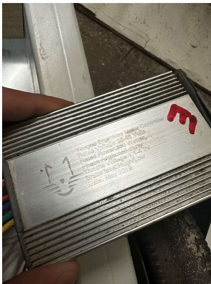
Slika 16. Drugi BLDC kontroler, Slika: Autor
