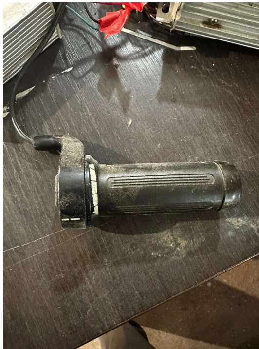
Slika 18. Vanjski potenciometar, Slika: Autor
