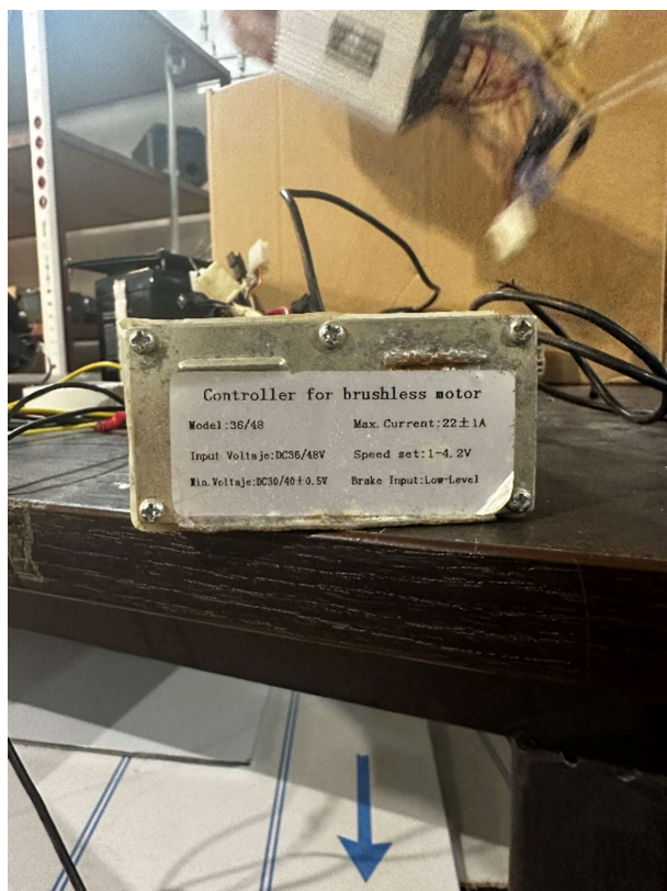
Slika 15. BLDC kontroler, Slika: Autor
