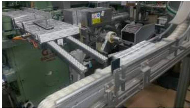
Slika 22: Transport gotovih šteka
