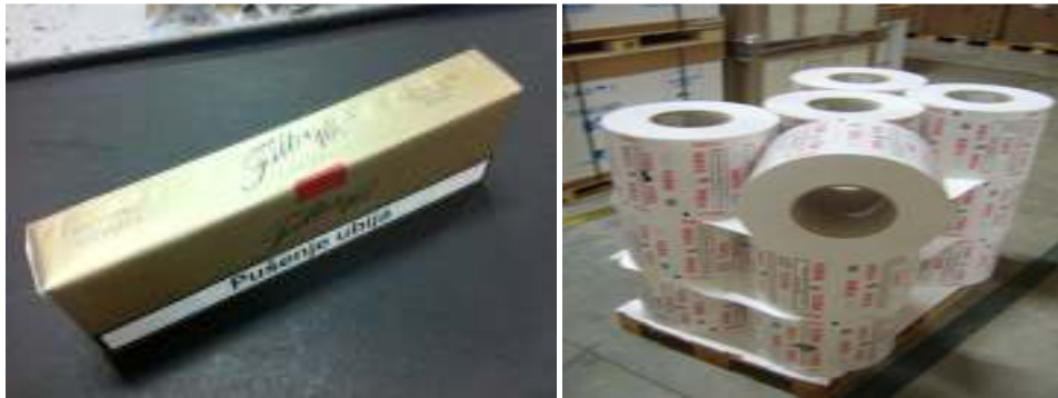
Slika 30: Papirna šteka (omotni papir) – pozicija u finalnom proizvodu i jedinica rukovanja
