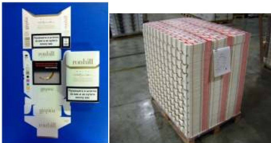
Slika 26: Kartonski prirez – pozicija u finalnom proizvodu i jedinica rukovanja
