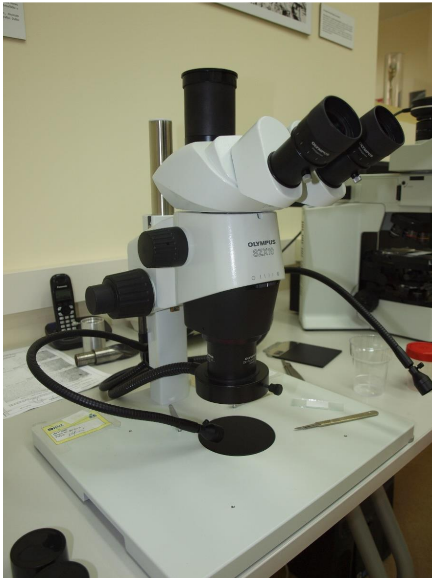
Slika 9. Optički stereomikroskop Olympus SZX10
