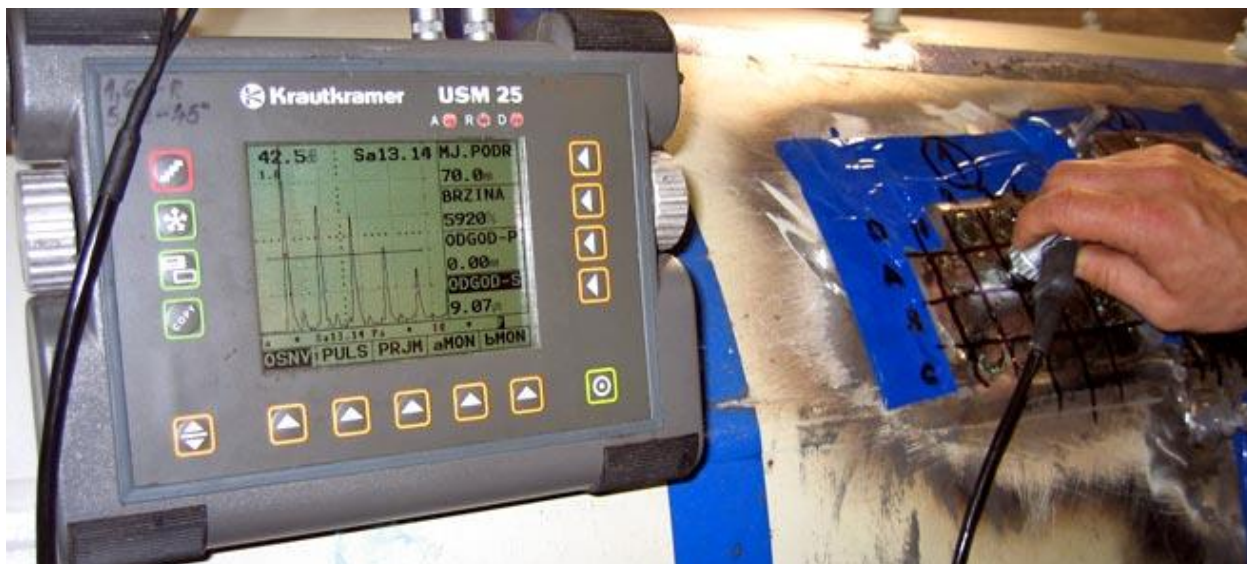
Slika 2. Ultrazvučno ispitivanje kvalitete zavarenog spoja
