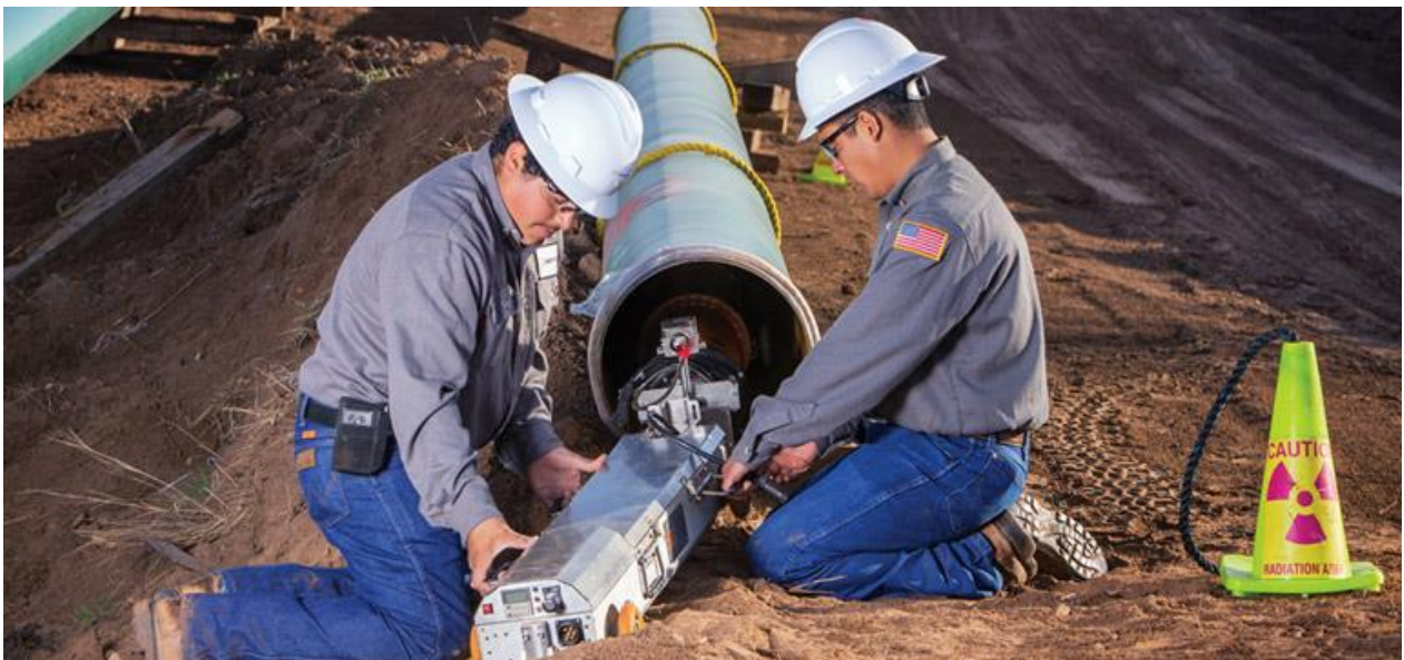
Slika 4. Radiografsko ispitivanje zavarenog spoja
