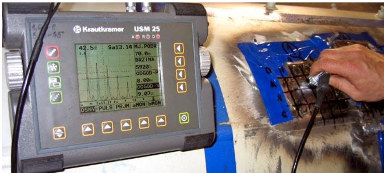
Slika 2. Ultrazvučno ispitivanje kvalitete zavarenog spoja
