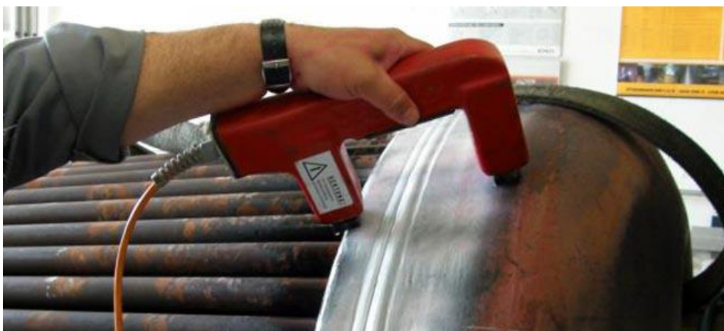
Slika 5. Magnetsko ispitivanje zavarenog spoja
