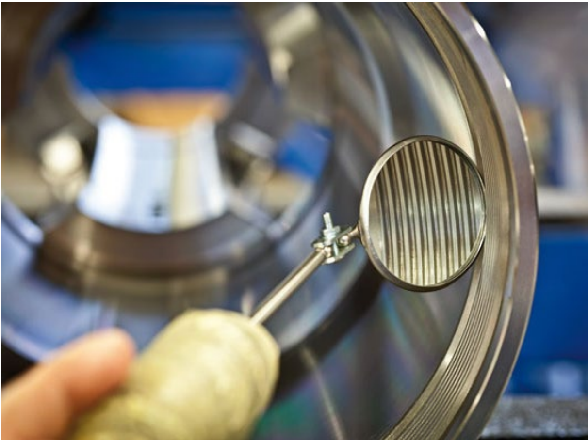
Slika 9 Primjer vizualne metode ispitivanja s pomagalom Izvor: https://xweld.hr/usluge/ispitivanje-zavarenih-spojeva
