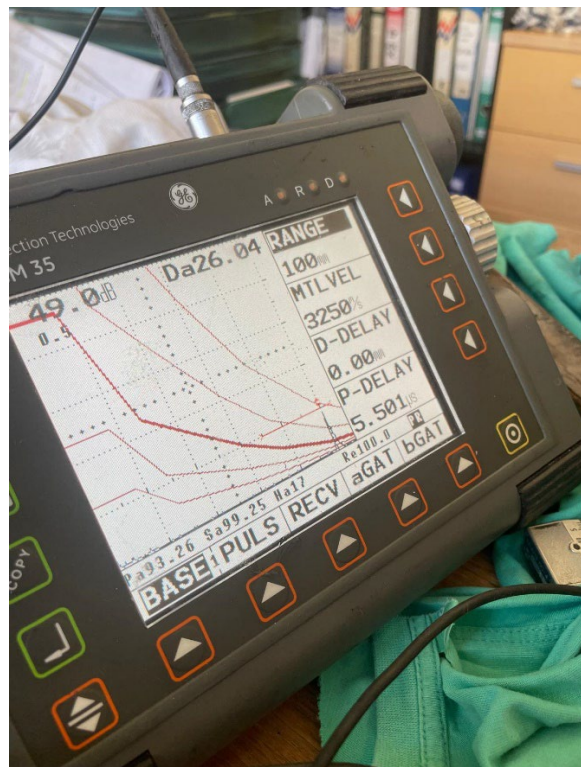
Slika 19 USM 35 uređaj pri kalibraciji
