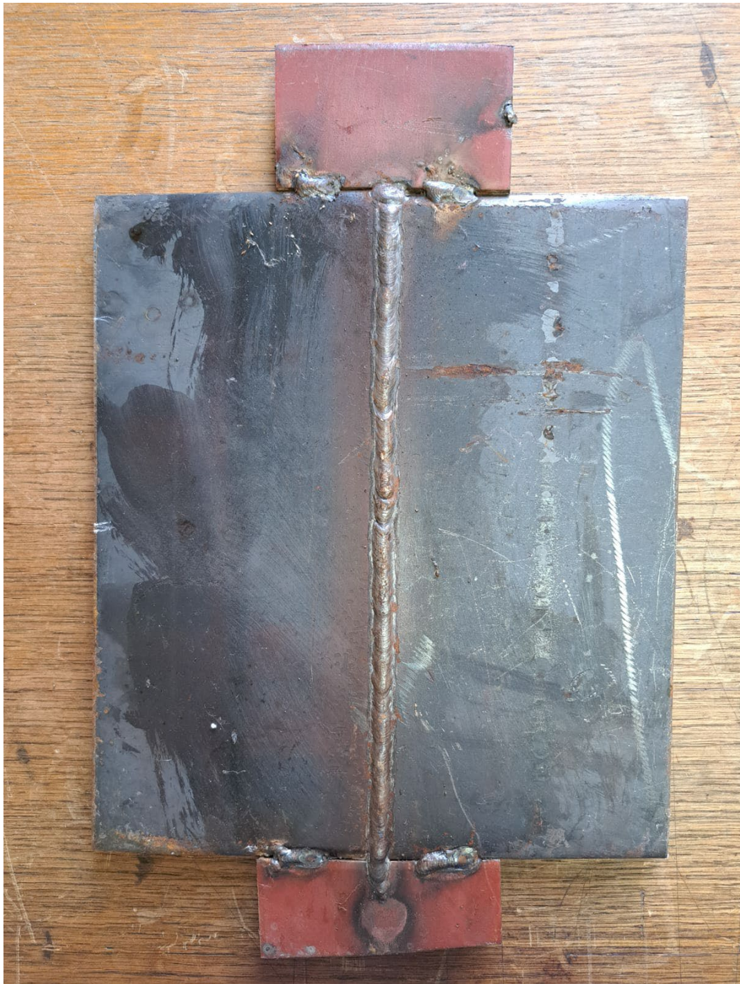
Slika 25 Ispitni objekt sa strane korijena zavara
