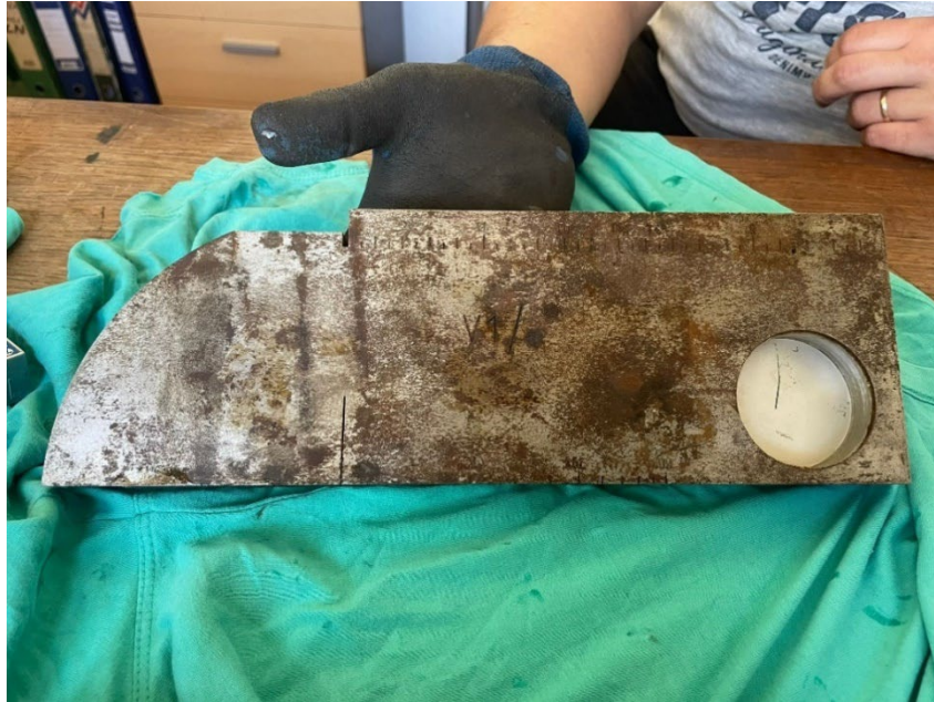
Slika 17 V1 Etalon za kalibraciju UZV uređaja
