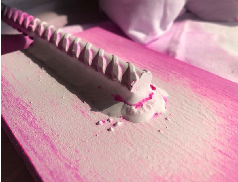
Slika 12 Penetrantska metoda kontrole Izvor: https://pondt.hr/penetrantska-kontrola/
