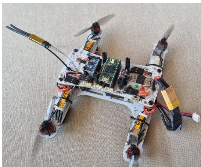
Slika 19. Cijeli kvadkopter nakon spajanja svih komponenti.
