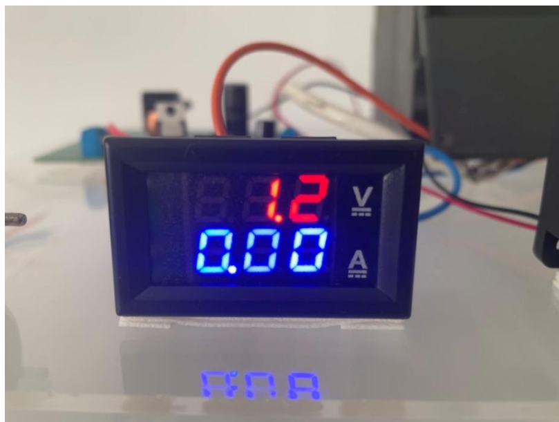
Slika 36: Minimalni izlazni napon prilagodnika
