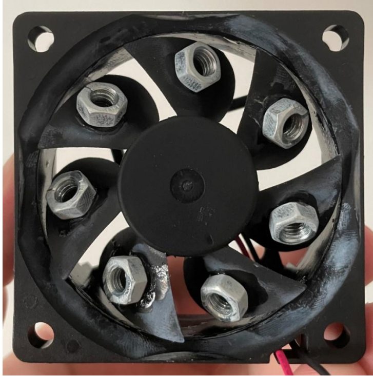
Slika 38: Dodatak matica na ventilator
