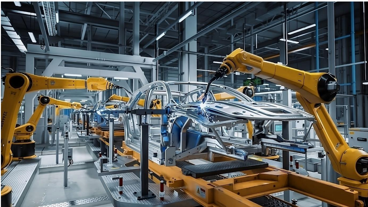
Slika 13: Prikaz zavarivanja dijelova automobila pomoću robotskih manipulatora Izvor: https://wevolver-project-images.s3.us-west-1.amazonaws.com/0.znmq5oj21rautomated_robotic_arms.jpg , Preuzeto: 06.09.2023.
