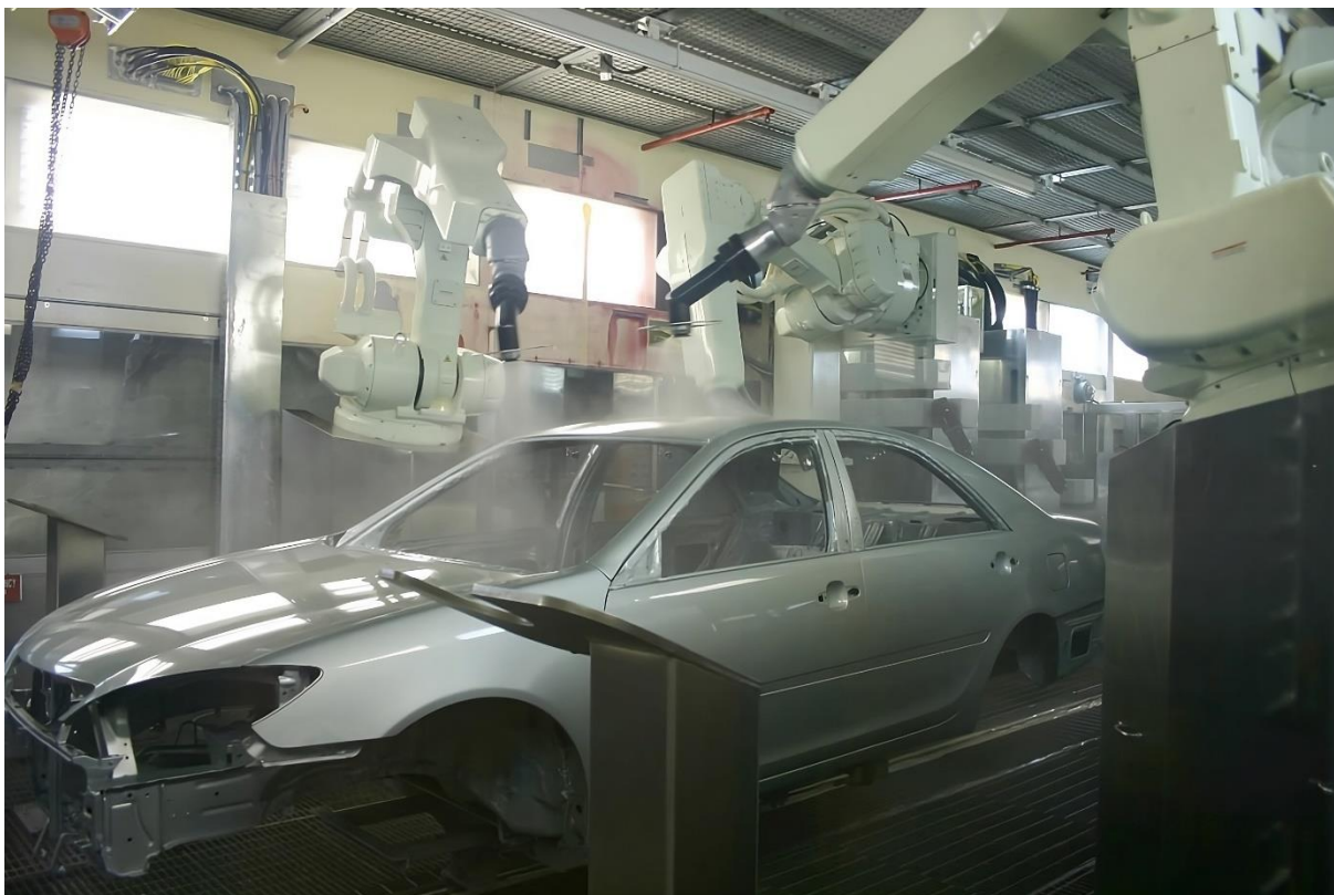
Slika 15: Prikaz bojanja pomoću robotskih manipulatora
