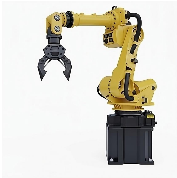
Slika 6: Prikaz robotskog manipulatora s hidrauličkim aktuatorom
