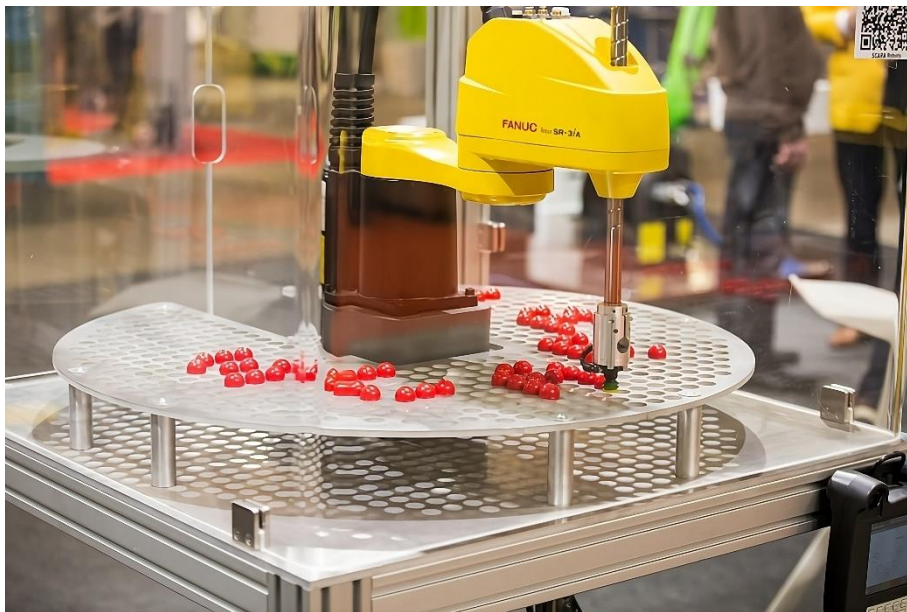
Slika 11: Prikaz robotskog manipulatora s SCARA konfiguracijom Izvor: https://howtorobot.com/sites/default/files/2021-09/scara-robot.jpeg , Preuzeto:05.09.2023.
