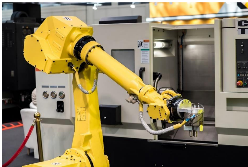
Slika 10: Prikaz robotskog manipulatora s polarnom konfiguracijom Izvor: https://processsolutions.com/wp-content/uploads/2018/10/AdobeStock_128955472.jpg ,Preuzeto:05.09.2023.
