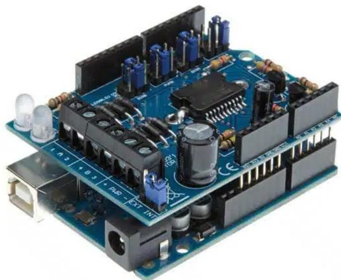
Slika 16: Prikaz dodatnog modula ili štita za proširenje funkcionalnosti Arduina. Izvor: https://soldered.com/learn/arduino-shield-everything-you-need-to-know/
