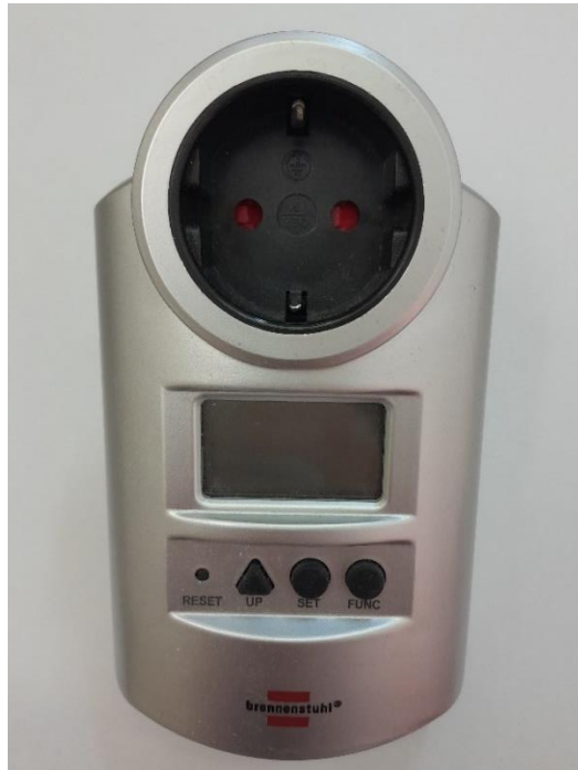
Slika 29: Fotografija pametne utičnice.
