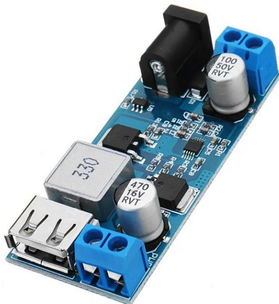
Slika 24: Prikaz DC-DC pretvarača XY 3606. Izvor: https://www.electroschematics.com/raspberry-pi-3/
