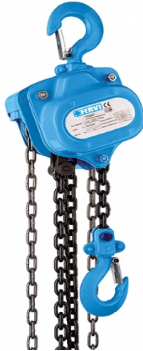
Slika 4. Ručna lančana dizalica 1t (Izvor: internetski portal www.alatimilic.hr )
