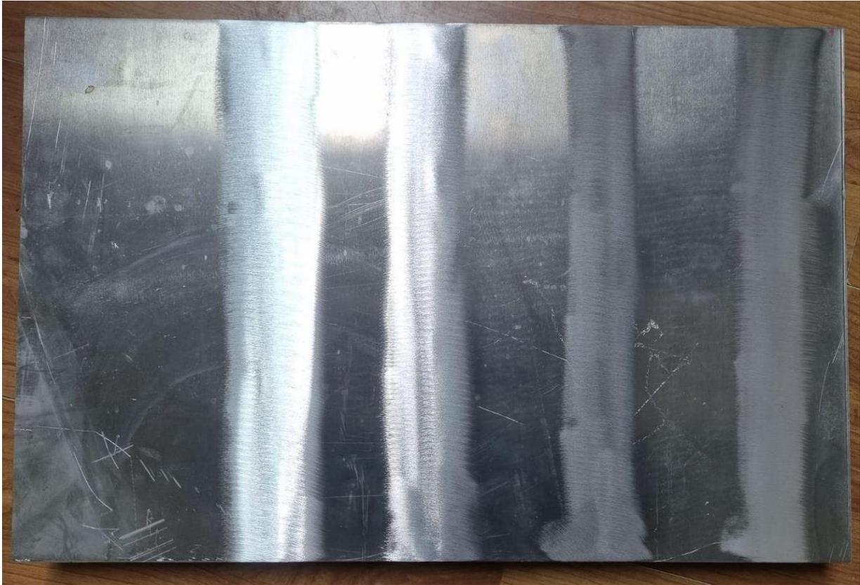
Lim na kojem je odrađena TIG procedura ravnjanja izrezan je na manje epruvete, promjera 40 mm (slike 5 i 6), koje se naknadno detaljnije prilagođava, u laboratoriju, kako bi bile pogodne za promatranje na mikroskopu.
