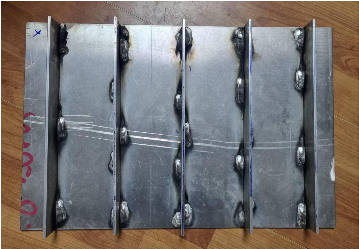
Slika 2. Pojačanja na trupu broda
