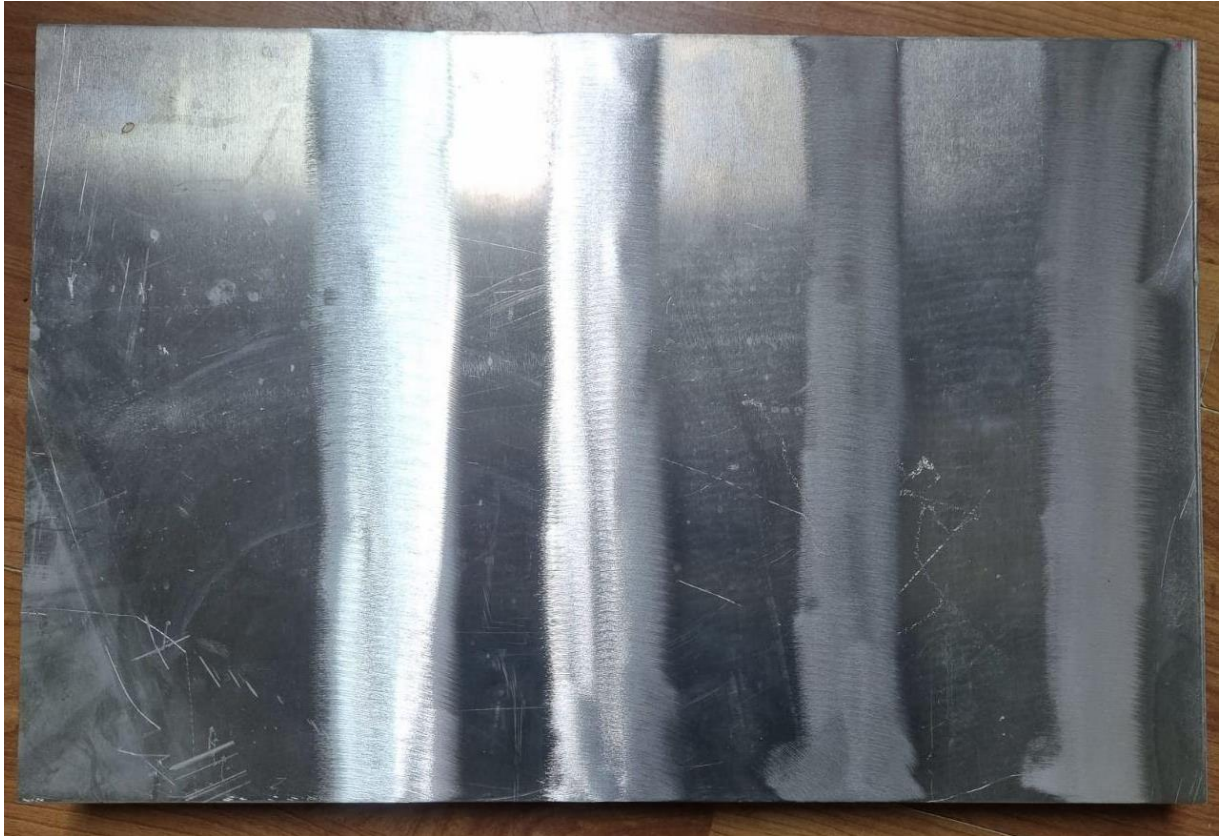
Slika 4. Odstranjen površinski sloj \text{Al}_2\text{O}_3
