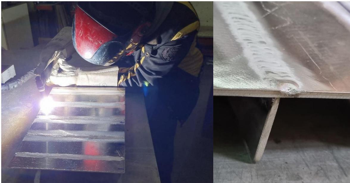
U procesu unosa topline elektroda je udaljena od površine, na koju se unosi toplina, 15 mm te je korišten zaštitni plin argon (100% Ar). Podaci o unosu topline prikazani su u tablici 2 te su dodane napomene vezane za različite načine pripreme uzorka. Uzorci P3 i P5 su pripremljeni na isti način no razlikuje se količina unesene topline.
