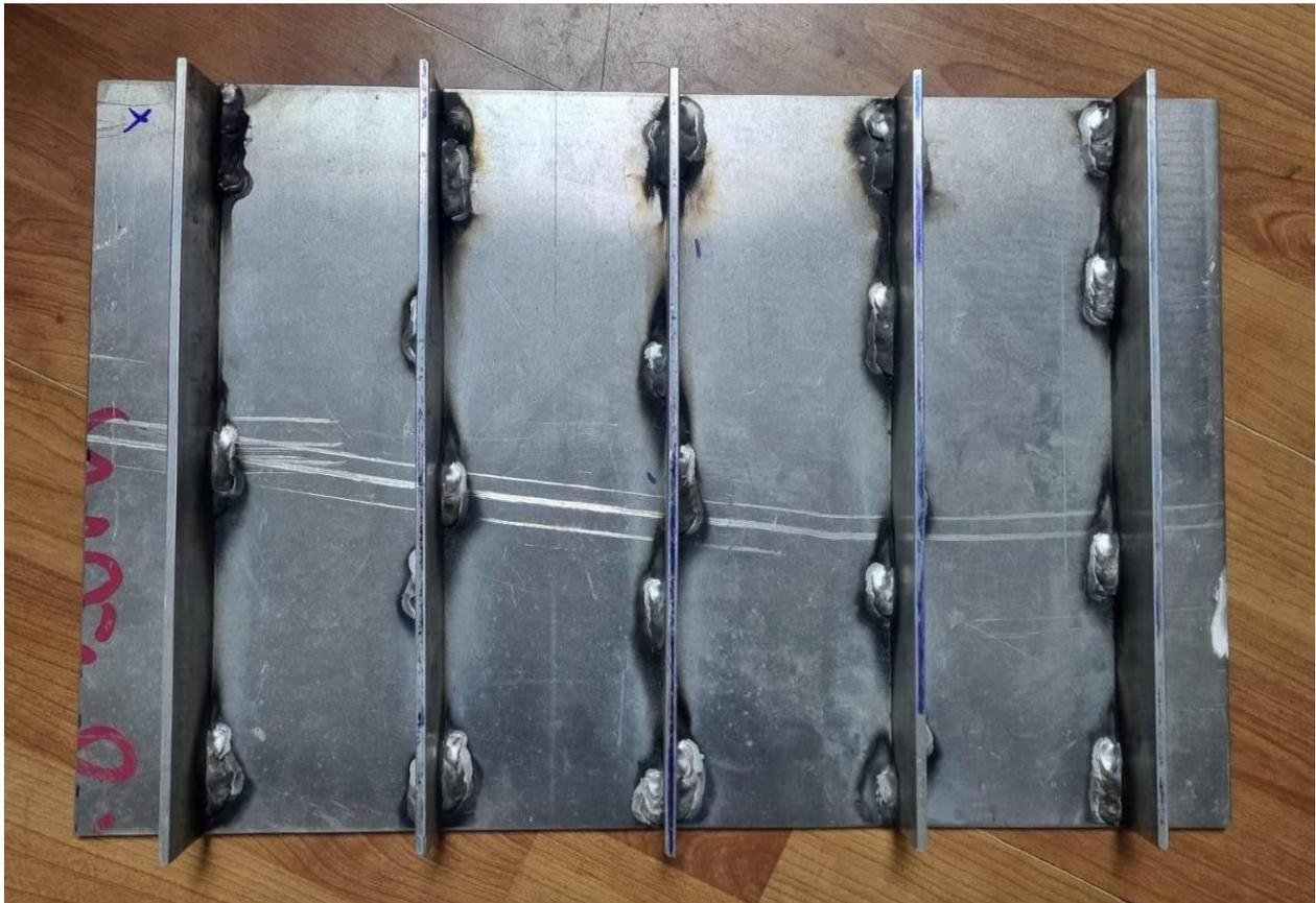
Na površini koja simulira trup broda, na kojoj se vrši unos topline, odstranjen je aluminijev oksid na četiri od šest uzoraka, od kojih je jedan referentni. Tako pripremljen „trup“ je spreman za unos topline koji se vrši prema nekoliko različitih vrijednosti unosa topline odnosno uvjeta. Zbog povjerljivih podataka poduzeća Tehnomont brodogradilište d.o.o. nije moguće otkriti sve parametre, no formula po kojoj je dobivena količina unosa topline je:
