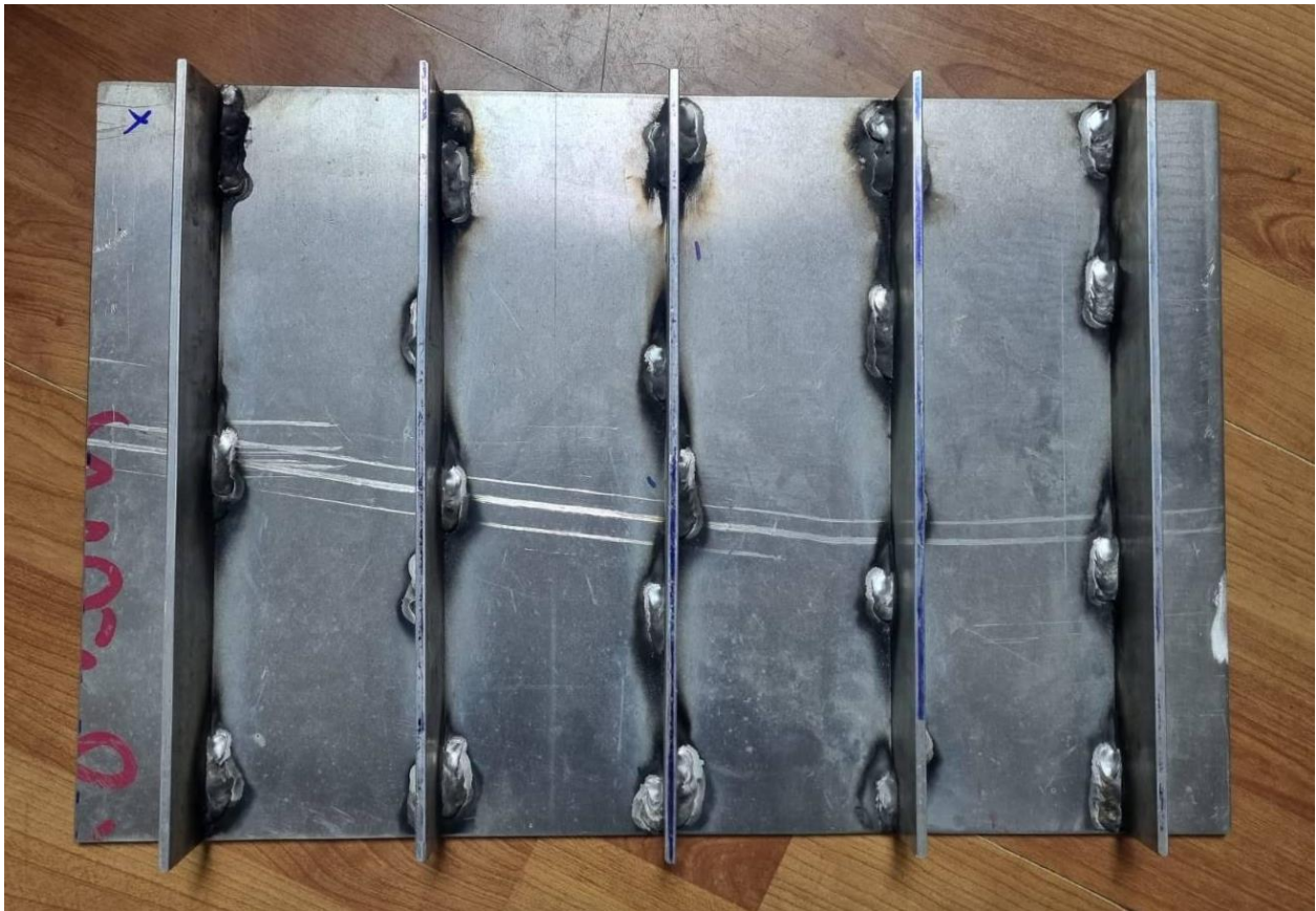
Slika 2. Pojačanja na trupu broda
