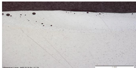
f) Mikrostrukturalna analiza uzorka (P5), područja zone utjecaja topline (ZUT), nakon ravnjanja limova sa TIG opremom
