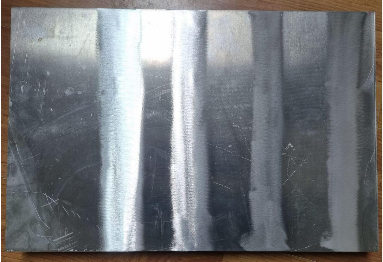
Slika 4. Odstranjen površinski sloj \text{Al}_2\text{O}_3
