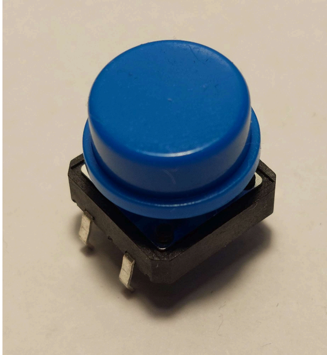
Slika 23: Prikaz jednostavnog tipkala
