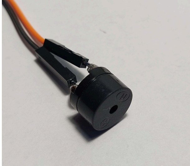
Slika 19: Piezzo električna zujalica
