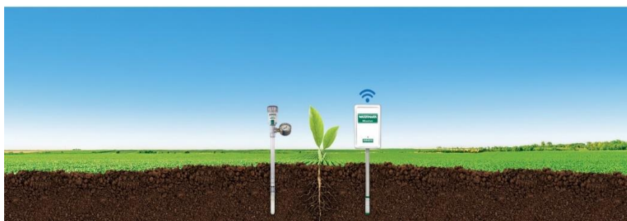
Slika 4: Prikaz postavljanja irrometra
