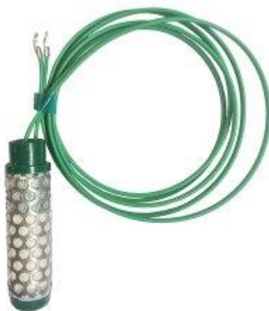
Slika 8: Primjer Watermark senzora
