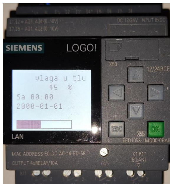
Slika 24: Prikaz podataka na logičkom kontroleru
