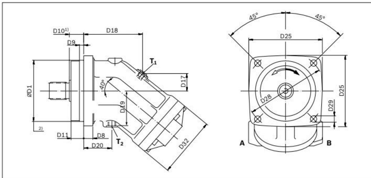
Slika 13. Shema hidromotora A2FM 6x - 23
