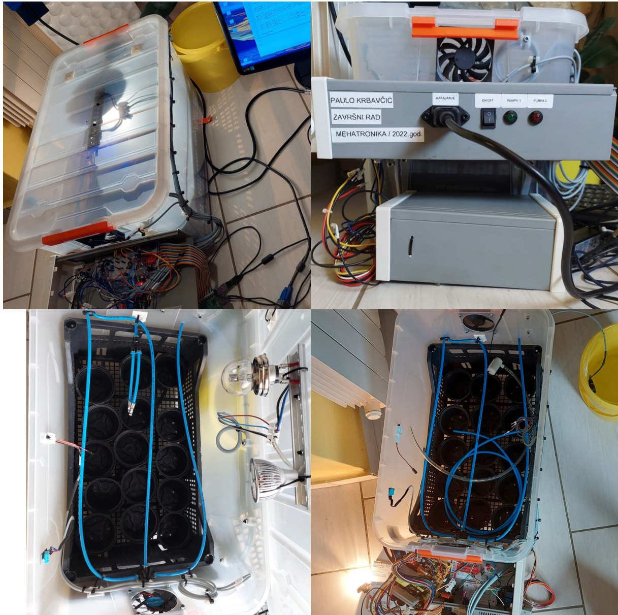
Slika 15. Sustav: Daljinsko upravljanje pametnim staklenikom, Slika: Autor
